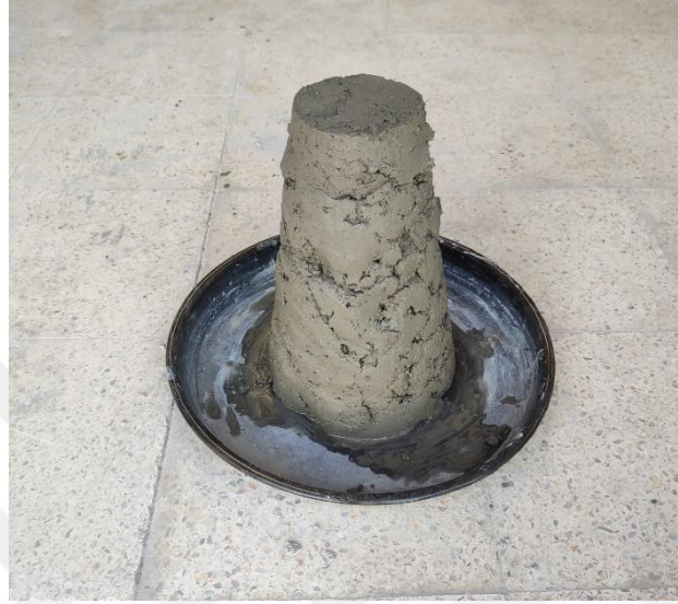
Şekil 4.2. Otomatik Yapı Üretimine Uygun Olarak Hazırlanmış Taze Beton Örneği
