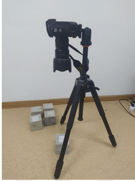
řekil 4.4. Numune Görüntülerini Elde Etmek İçin Hazırlanan Düzenek
