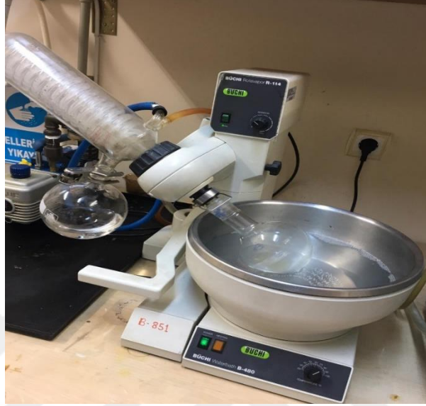
Şekil 3. 4. Yağ değerinin belirlenmesi için damıtma işleminde kullanılan rotary evaporatörü
