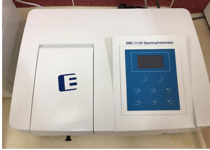
Şekil 3. 5. TBARS değerin belirlenmesinde kullanılan spektrofotometre cihazı
