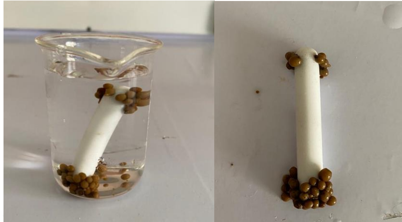
Şekil 3.6. Manyetik kitosan-kil boncuklarının manyetik olarak ayrılmasının gösterilmesi
