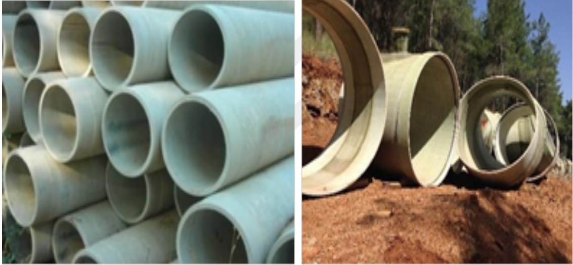
Şekil 3.3. Asbest boru örnekleri
