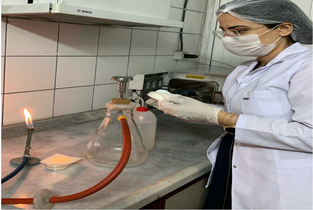
Şekil 3.6. Membran filtrasyon yöntemi ile su analizi
