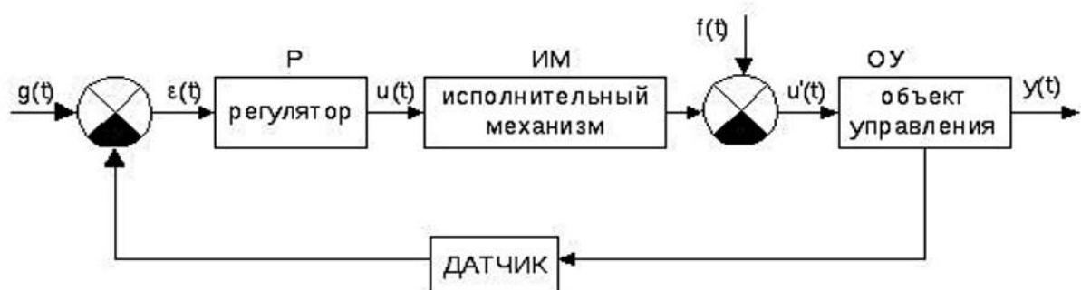
Рисунок 4 - Структурная схема контура автоматического регулирования с основными элементами управления
