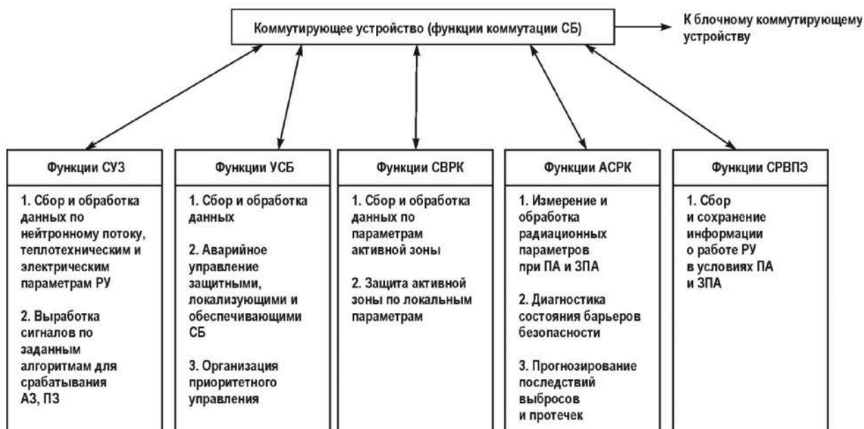
Рисунок 14 - Функциональная структура АСУ ТП в части контроля и управления системами безопасности
