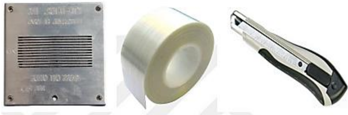
Şekil 3. 4. Kareleme testinde kullanılan malzemeler
