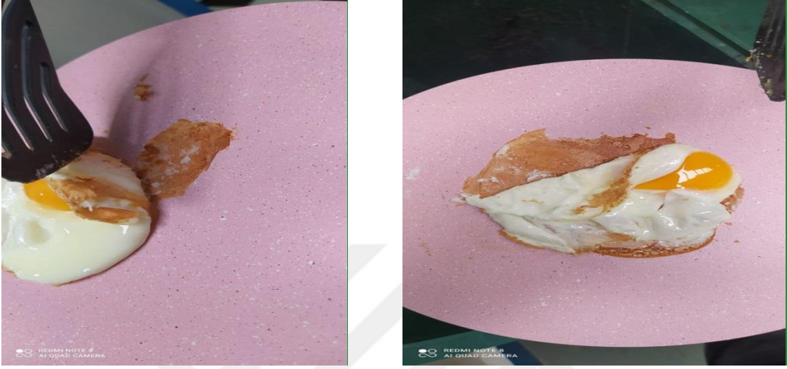
Şekil 4. 2. Yumurta testi bulguları
