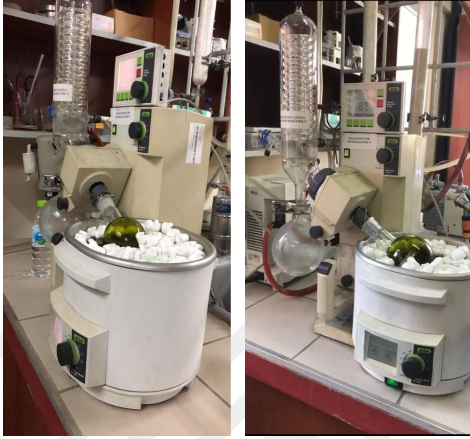
Şekil 3.2. Melocan ekstraktından etanolün uçurulması
