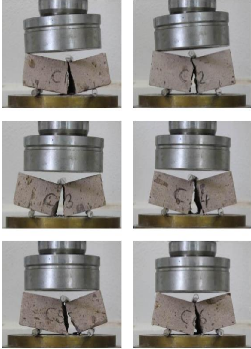
Şekil 5.5. Yığma birimlerin eğilmede çekme dayanımı testleri (C1-C6 numuneleri) (Uslu, 2013).
