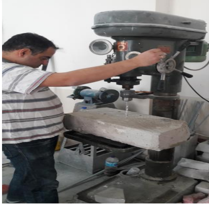
Şekil 5.1. Taşlara deliklerin açılma işlemi.
