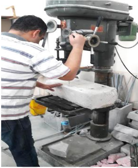
Şekil 5.12. Sabit matkap yardımıyla deliklerin açılması.
