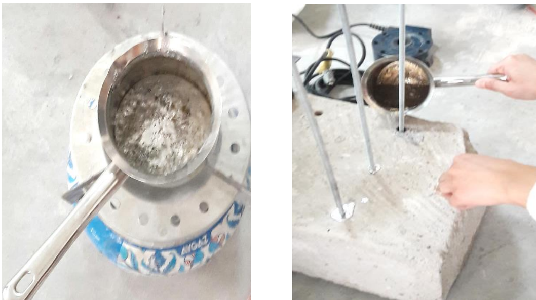
Şekil 5.14. Kurşunun eritilmesi ve deliklere doldurulması.
