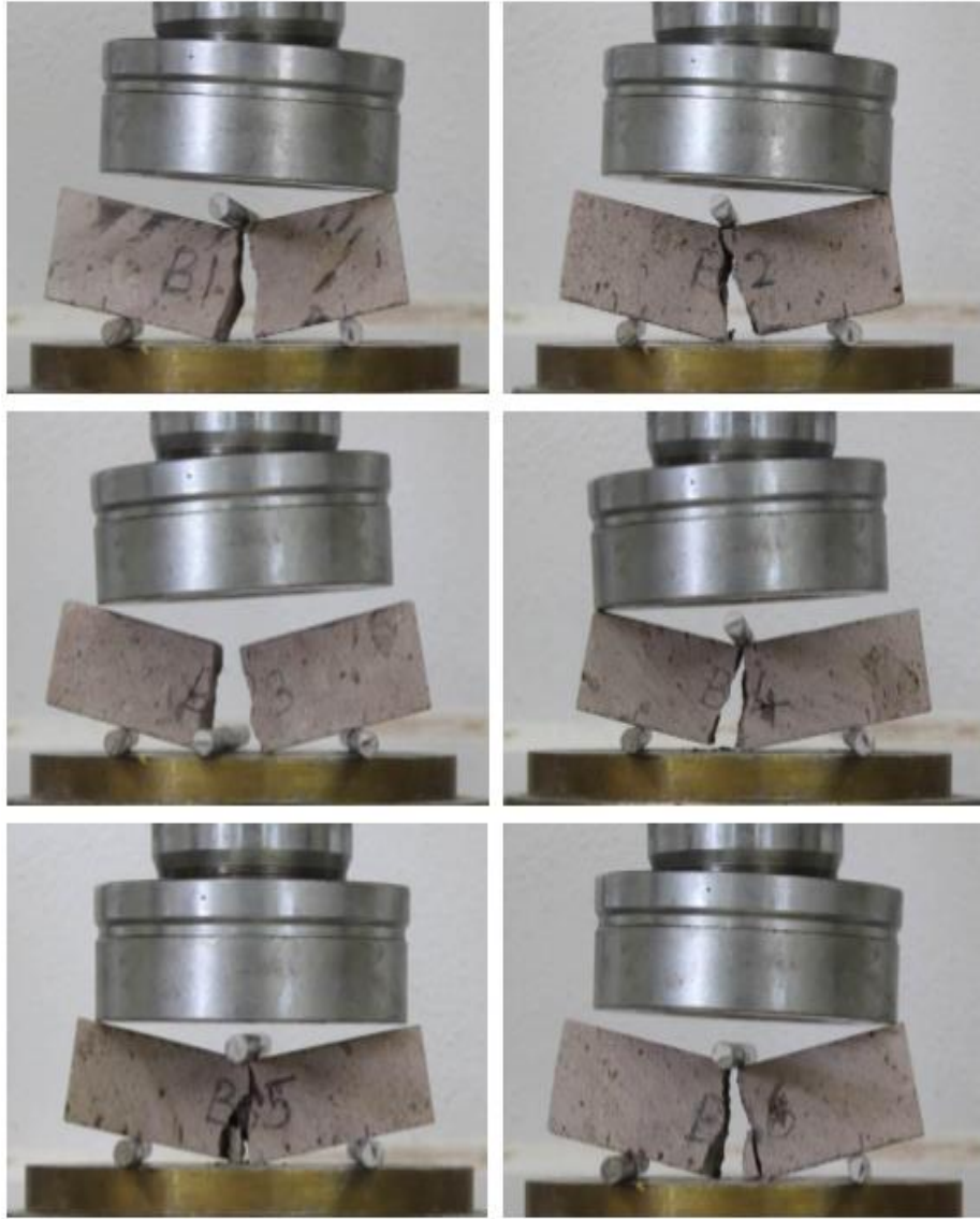
Şekil 5.4. Yığma birimlerin eğilmede çekme dayanımı testleri (B1-B6 numuneleri) (Uslu, 2013).
