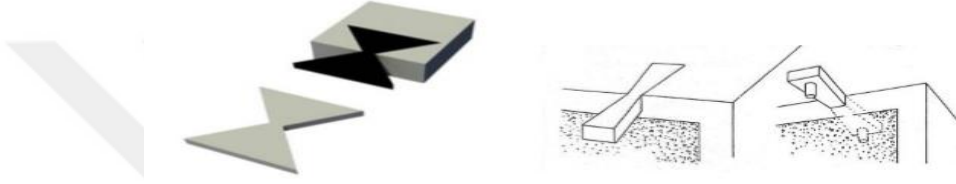
Şekil 4.2. Kırlangıç kuyruğu kenet (Koçak, 2013).
