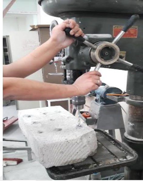
Şekil 5.12. Sabit matkap yardımıyla deliklerin açılması.
