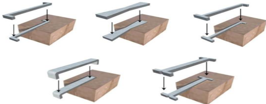
Şekil 4.7. Yığma yapılarda kullanılan farklı kenet tipleri (Uslu, 2013).
