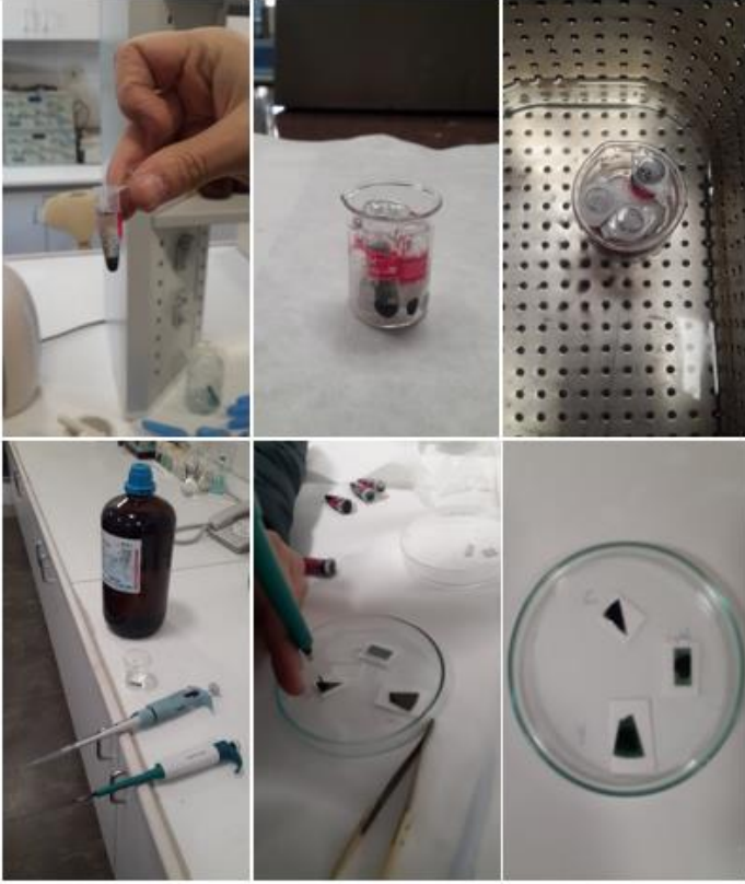
Resim 3.3. MWCNT çözeltisinin hazırlanması ve damlat kurut yöntemi yarıiletken üzerine aktarılması işlemi
