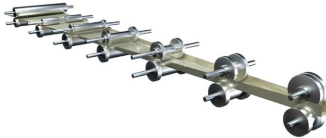
Şekil 2.1 : Rollform prosesi ile sac şekillendirme
