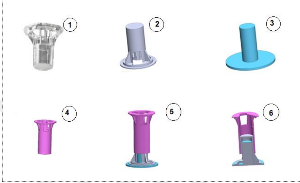
Şekil 4.1. Solid Works programı ile çizilen adaptör modelin bileşenleri. (Model-1) (1) Orijinal transwell, (2) Transwell’in ters çevrilmiş hali, (3) İki numarada gösterilen transwell’in içine geçecek; membranin ters yüzeyine ekim sırasında sızıntı yapmayan, zemine paralel oturan parça (alt adaptör), (4) Ters ekim sırasında transwell’e geçirilen ve transwell’deki üçgen alanlara kadar aşağıya ilerletilecek parça (üst adaptör), (5) Alt-üst adaptör ve transwell montajının dıştan görünümü (2, 3 ve 4 numaralı resimlerin montajı), (6) Alt-üst adaptör ve transwell montajının kesit görünümü.
