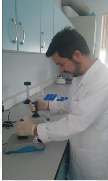
Şekil 3.10. Falkon tüp içindeki sediment karışımının vortekslenmesi
