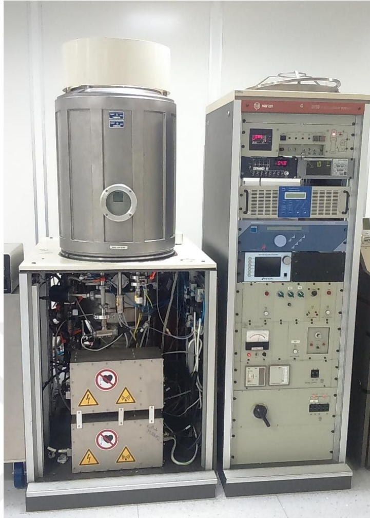
Şekil 5.1 Manyetik alanda sıçratma sistemi
