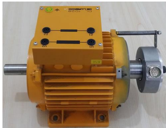
Şekil 5.9. Sürekli yardımcı sargılı tek fazlı asenkron motor
