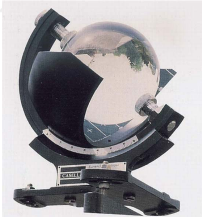
Şekil 3. 2. Campbell-Stokes helyografı (DMİ, 2005)
