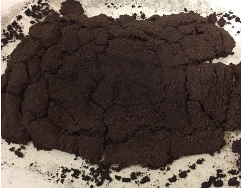
Şekil 4.4: Isıtma işlemi sonucunda üretilen \text{Li}_{1,2}\text{Ni}_{0,2}\text{Co}_{0,08}\text{Mn}_{0,52}\text{O}_2 tozu.
