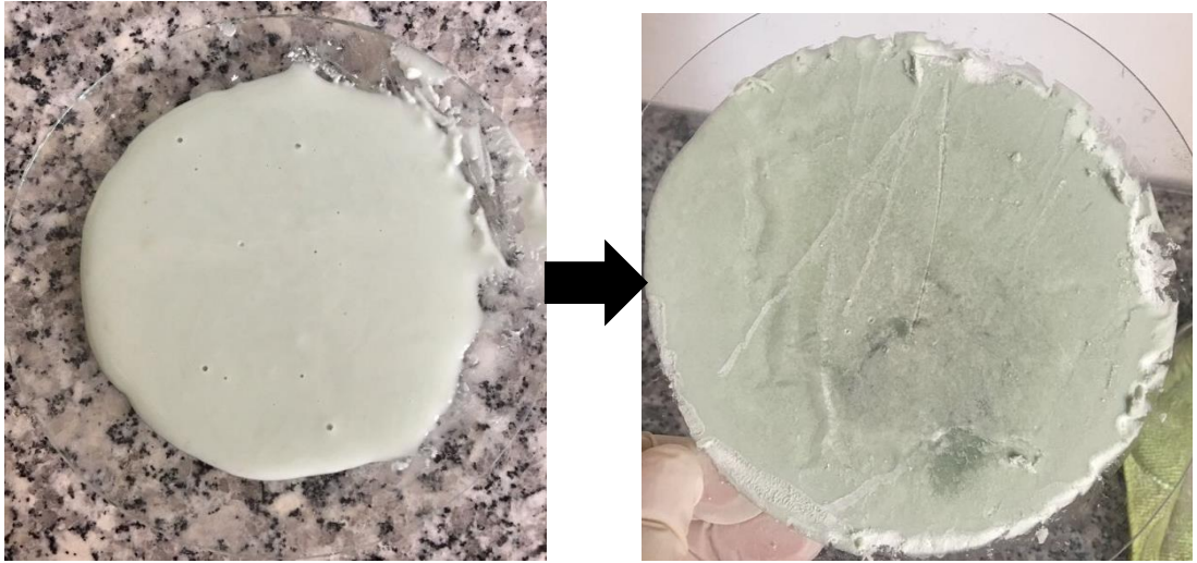
Şekil 4.3: Jelin 100°C’de kurutulması sonucu meydana gelen değişim.
