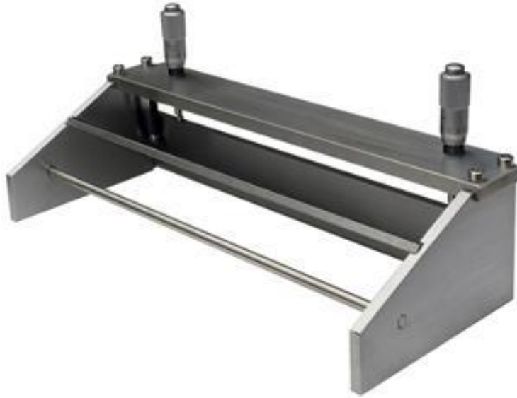
Şekil 3.10: Laminasyon cihazında kullanılan bıçak (Doctor Blade) [61].
