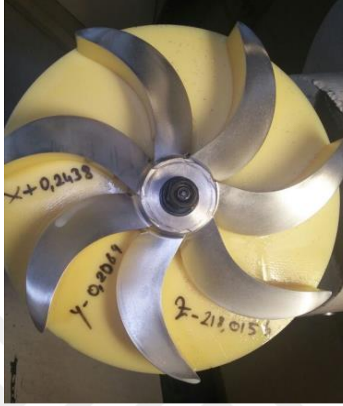
Şekil 4.8: Kompozit destek ve işlenmiş formda pervane.
