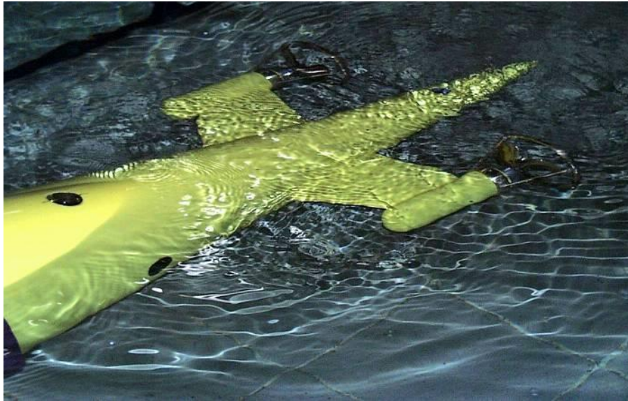
Şekil 2.21: Serbest akış içinde model karakteristiğini bulmak için yapılan bir çalışma, SVA Potsdam [24].
