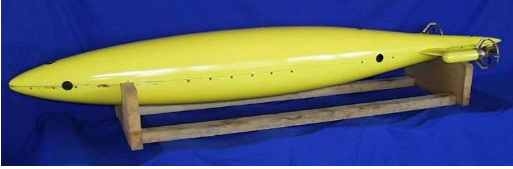
Şekil 2.19: Serbest akış içinde model karakteristiğini bulmak için yapılan bir çalışma, SVA Potsdam [24].
