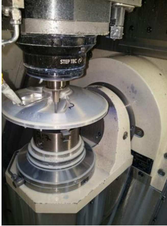
řekil 4.7: Pervanenin CNC'de iřlenmesi.
