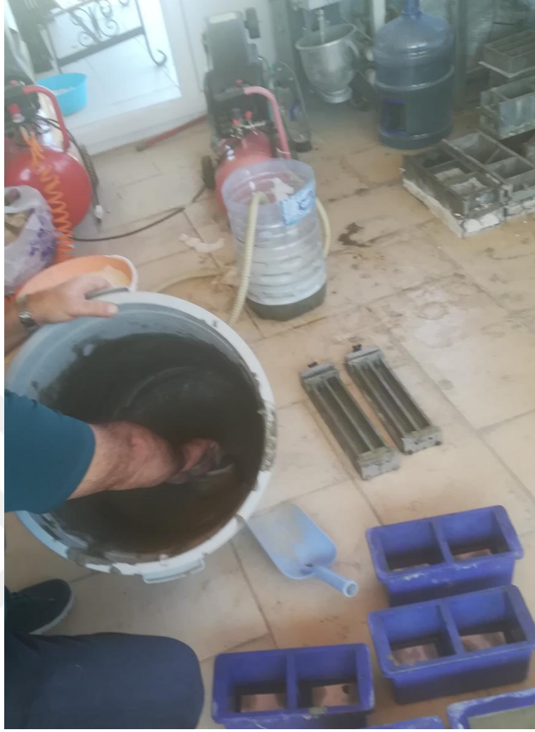
Şekil 3.2. Köpük beton üretimi
