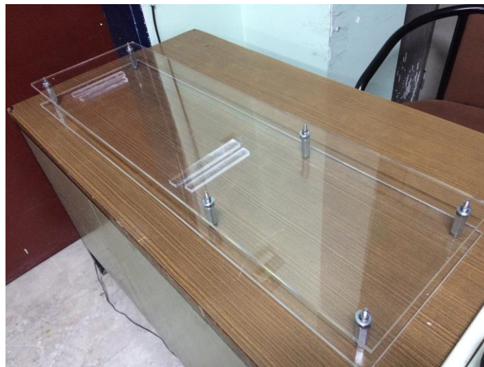
Şekil 3.7. PIV deneylerinde kullanılan düz plaka modeli
