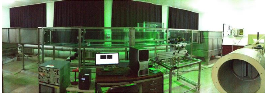
Şekil 3.5. PIV deney düzeneği (Yağmur, 2016)
