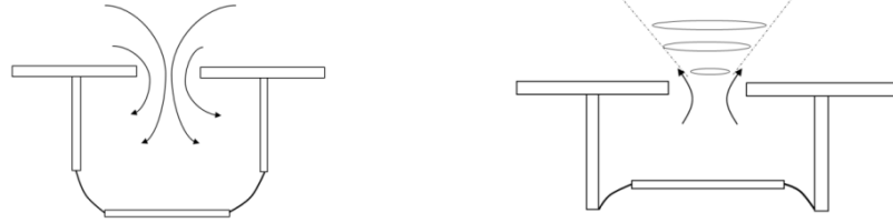
Şekil 5.16. Sentetik jet sistemi(emme-püskürtme).
