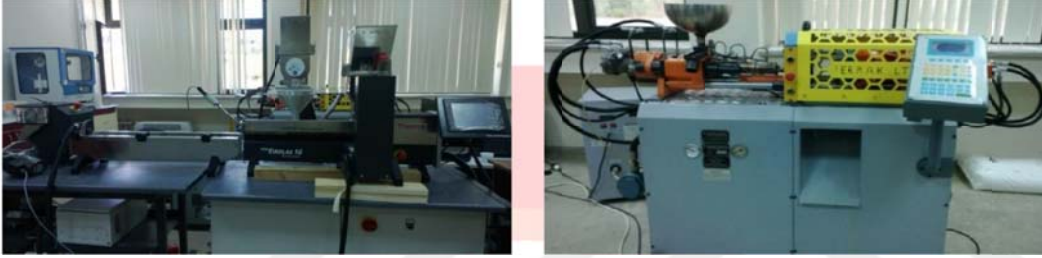
Şekil 4.1. a) İkiz vidalı rotasyonel ekstrüder, b) Enjeksiyon kalıplama makinesi.
