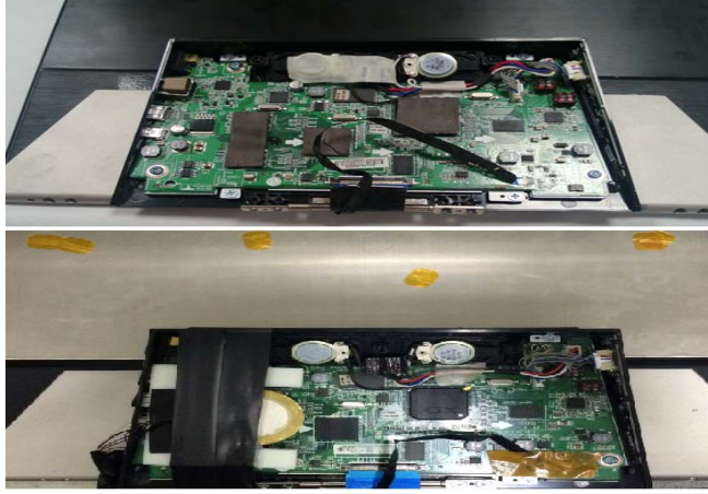
Şekil 5.31. Anakart üzerinde piezoelektrik fan yerleşimi.
