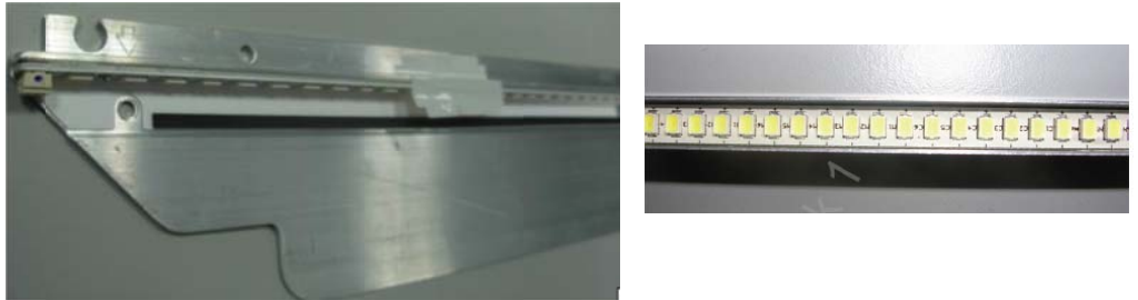
Şekil 2.12. Kenardan aydınlatmalı LED arka aydınlatma mekanik yapısı ve LED dizilişi (Vestel Elektronik izni ile).
