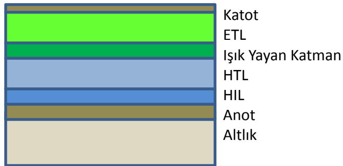
Şekil 2.18. Küçük molekül OLED katman yapısı.
