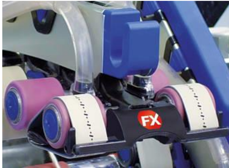
Şekil 3.6 Zinser KİES ve delikli apron (Zinser 351 2Impact FX Broşürü)
