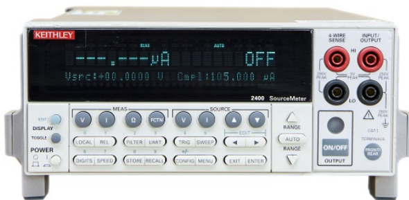
Resim 3.3. Keithley 2400 akım-voltaj kaynağı
