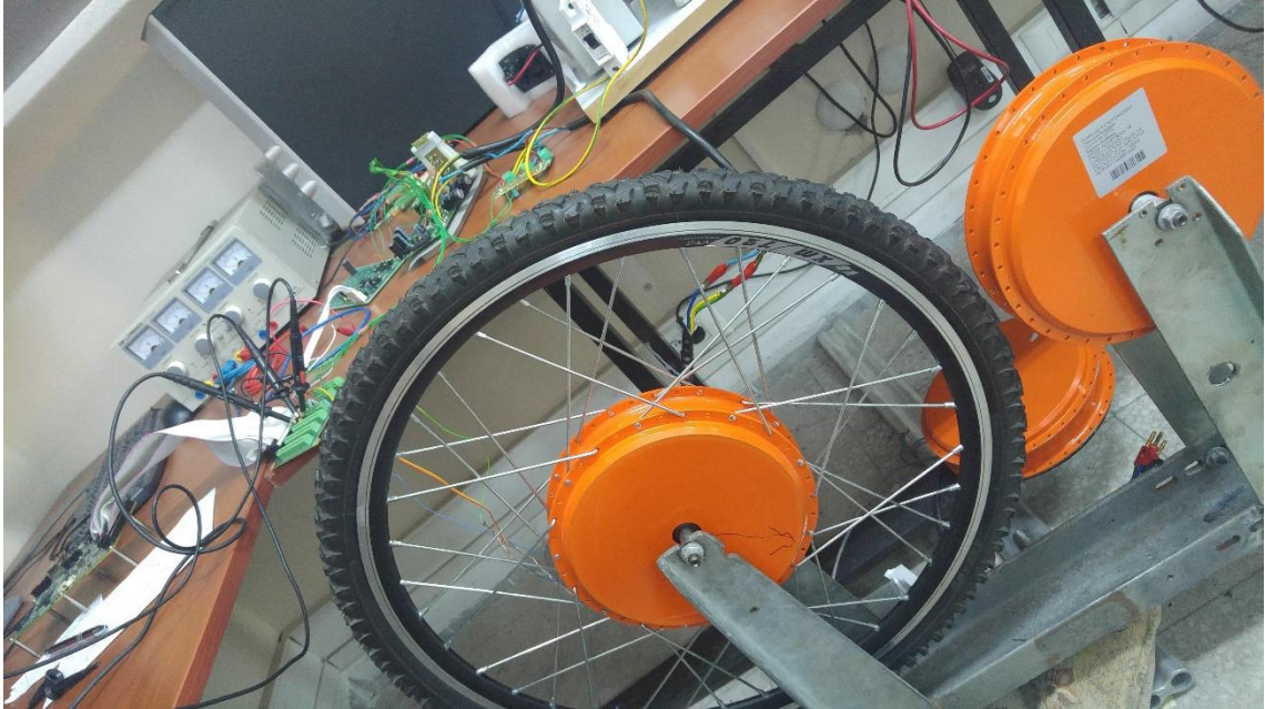
Şekil 6.1 1kW FSDA motor deney düzeneği
