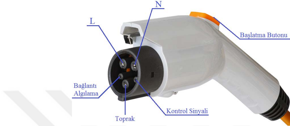
Şekil 2.3. Seviye 1 için bağlantı aparatı (SAE J1772/IEC 62196-2).
