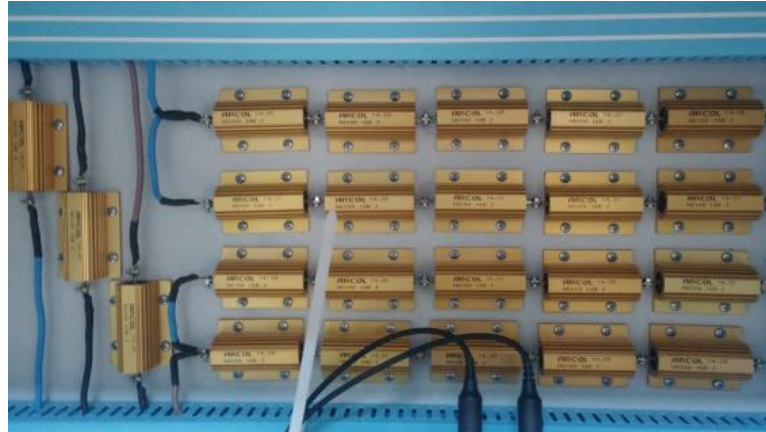
Şekil 5.25. Tasarlanan sistemdeki ön direnç grupları.
