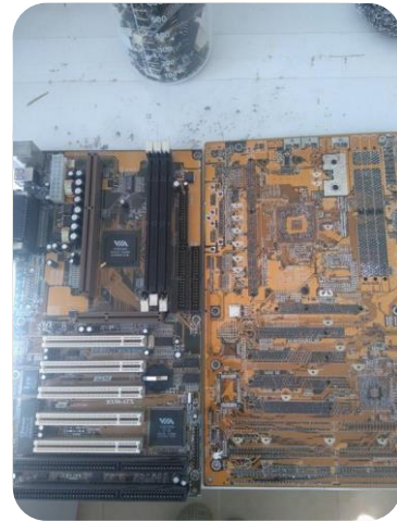
Şekil 7.12. Kullanım ömrünü tamamlamış Nokia 3310 telefon kartları ve masaüstü bilgisayar baskılı devre kartları
