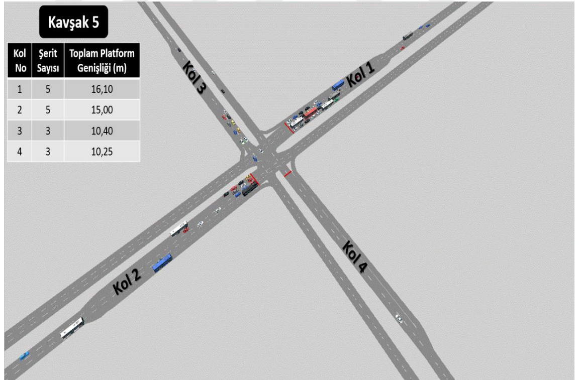
Şekil 4.56. Kavşak 5'in DE-INT tarafından önerilen yeni geometrik özelliklere göre Vissim programı yardımıyla analizi.
