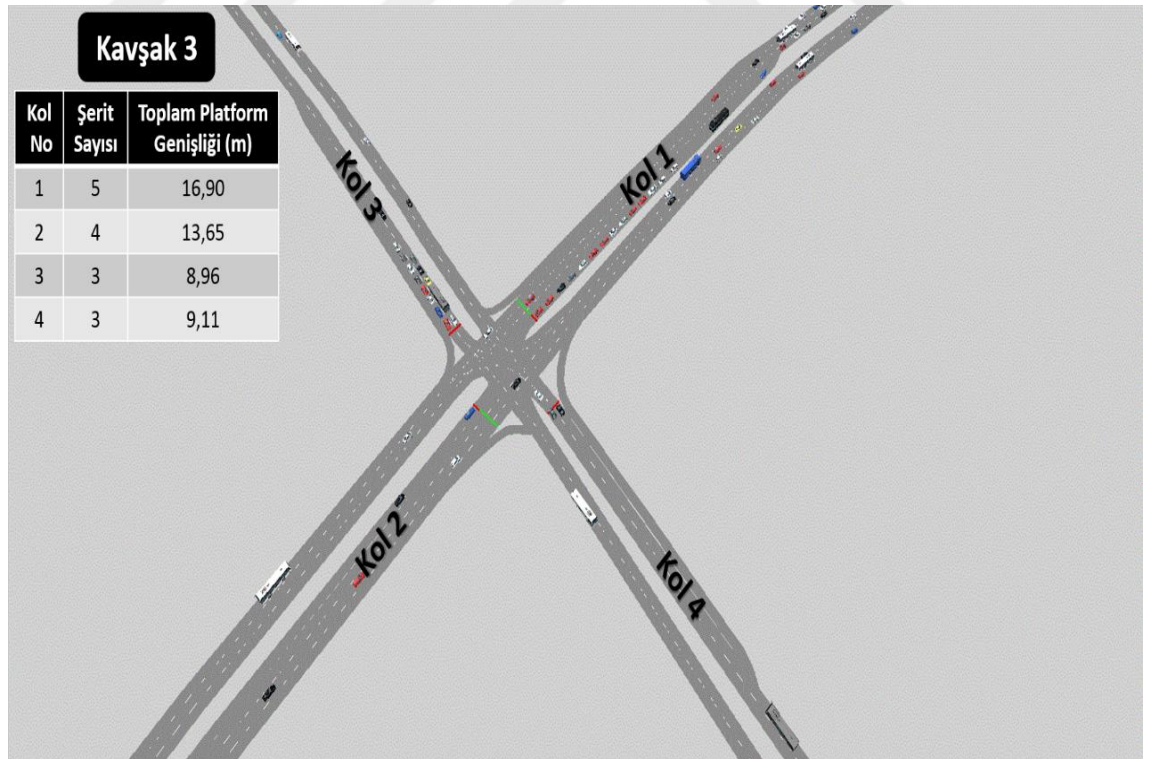
Şekil 4.54. Kavşak 3'ün DE-INT tarafından önerilen yeni geometrik özelliklere göre Vissim programı yardımıyla analizi.
