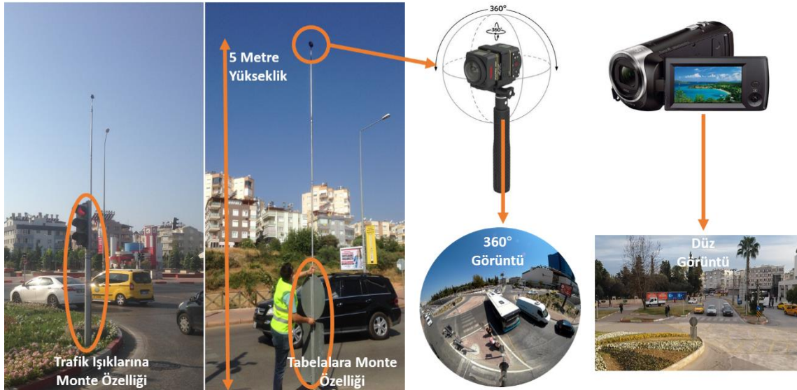
Şekil 3.13. İncelenen kavşaklardan video kamera sistemleri yardımıyla verilerin toplanması.
