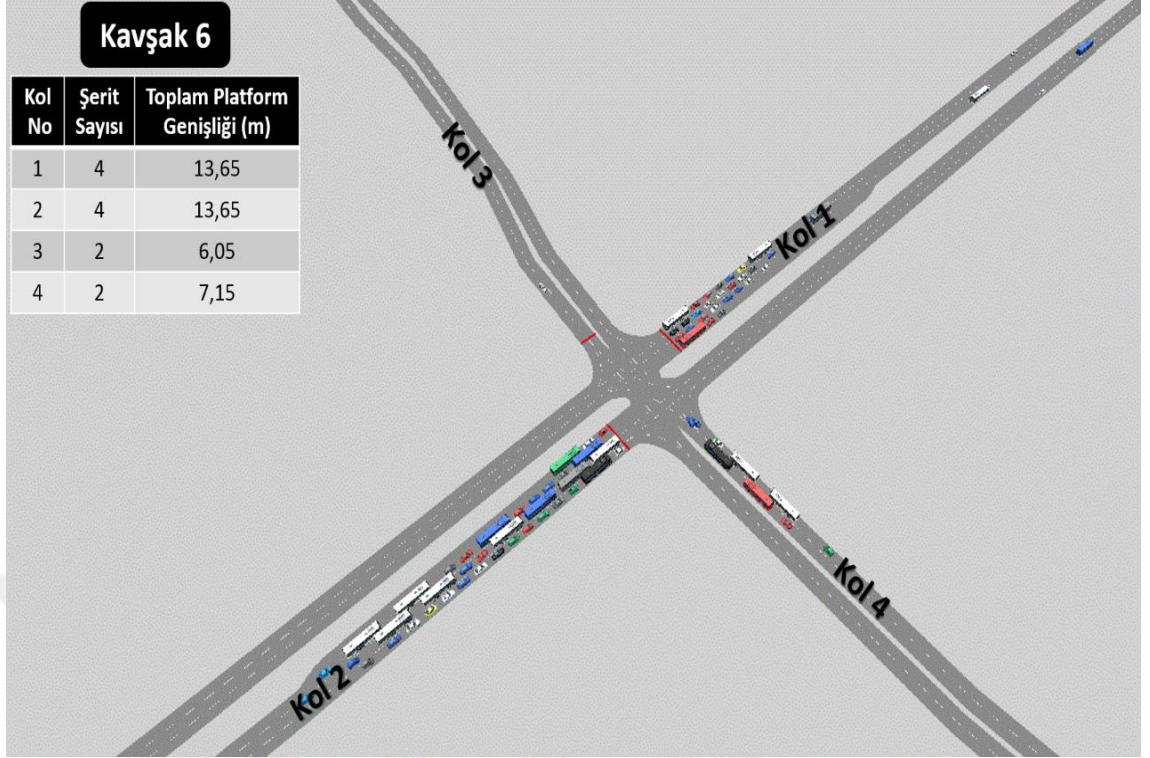
Şekil 4.57. Kavşak 6'nın DE-INT tarafından önerilen yeni geometrik özelliklere göre Vissim programı yardımıyla analizi.
