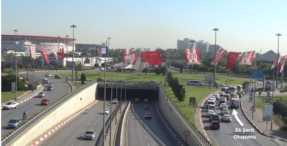
Şekil 1.2. Antalyaspor kavşağında iki şeritli kolda üç şeritli kuyruk oluşumu.
