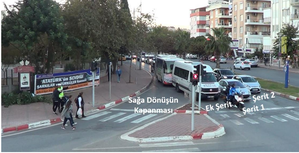
Şekil 1.1. Antalya il sağlık kavşağında gözlemlenen illegal ek şerit oluşumu ve bunun sonucunda sağa dönüşün kapanması.
