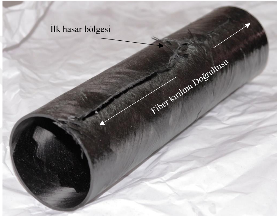
Şekil 5.7. Numunelerde görülen iç basınç testi hasarı
