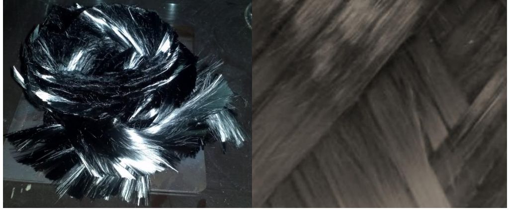
Şekil 5.4. Yakma testi sonrası karbon fiber takviye malzemesi
