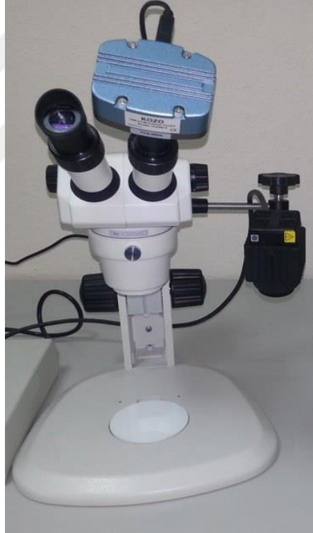
Şekil 4.27. Mikro hasarın incelenmesinde kullanılan KOZO USB mikroskop kamera
