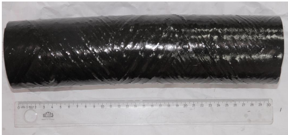
Şekil 5.8. Numunelerde görülen iç basınç testi hasarı ve eğilme
