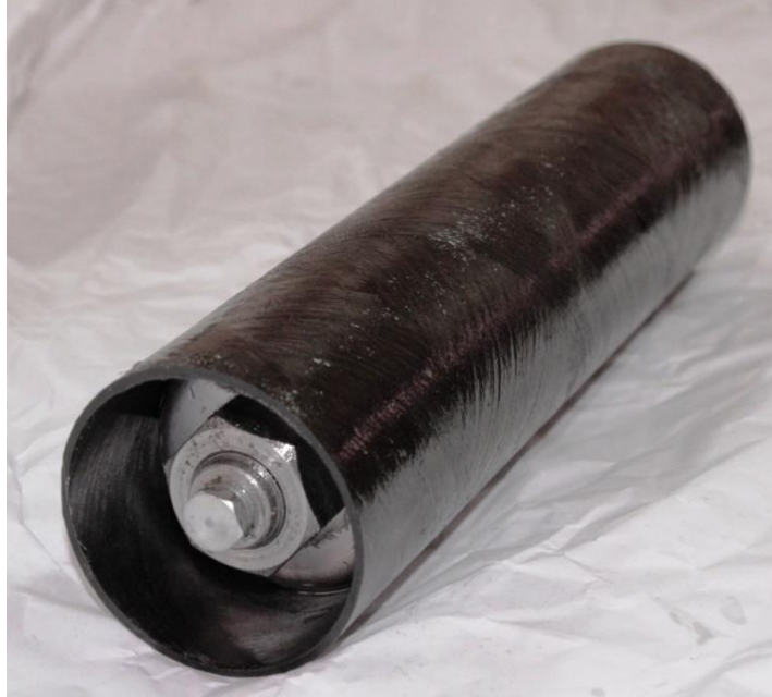
Şekil 4.13. Boruya iç basınç test aparatı montajı
