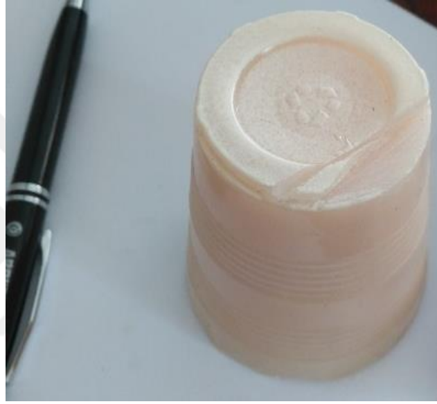
Şekil 4.25. Epoksi matristen SEM numunesi hazırlanması
