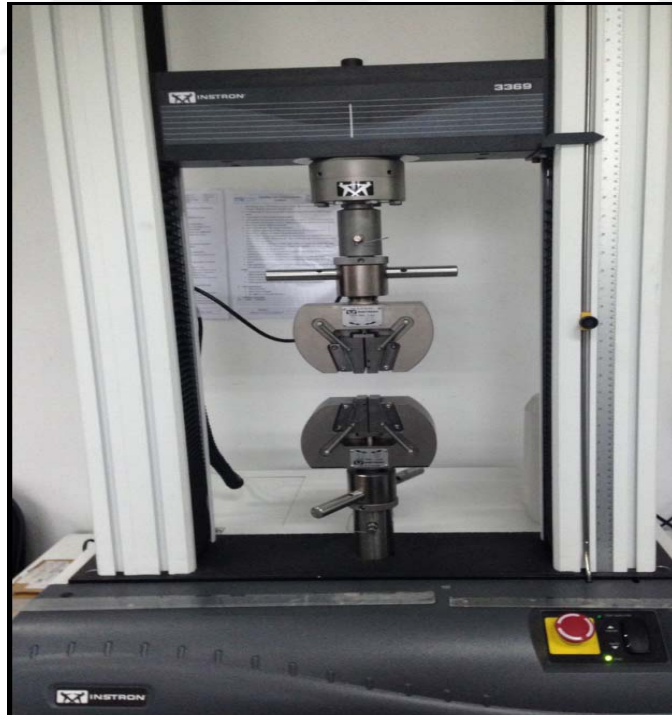
Şekil 3.1 Instron3369 Universal Çekme Test Cihazı
