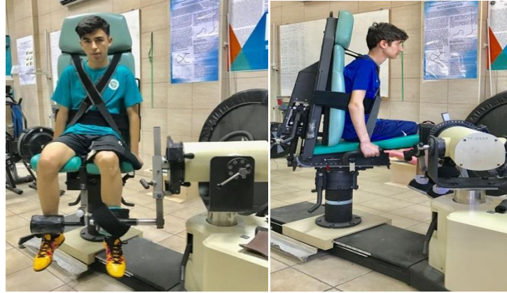
Şekil 3.8. Diz ekstensiyon/fleksiyon ve izometrik kuvvet ölçümü
