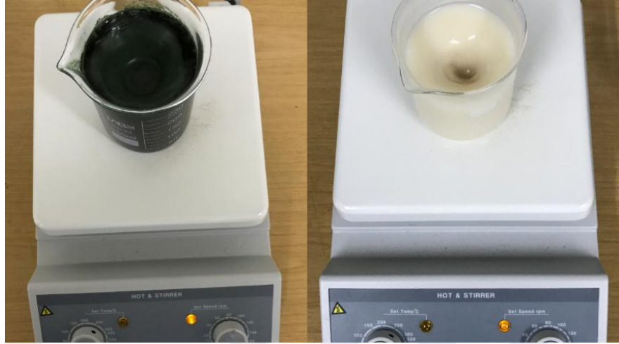
Şekil 2.5. Midyelerin beslenmesi sırasında alg süspansiyonunun homojen kalması için kullanılan manyetik karıştırıcı
