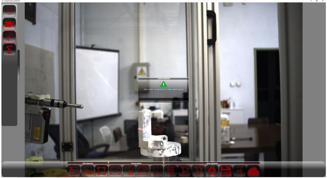
Görsel 3.13. Lazer Profil Tarama İlk Pozisyonuna Robotun Gönderilmesi
