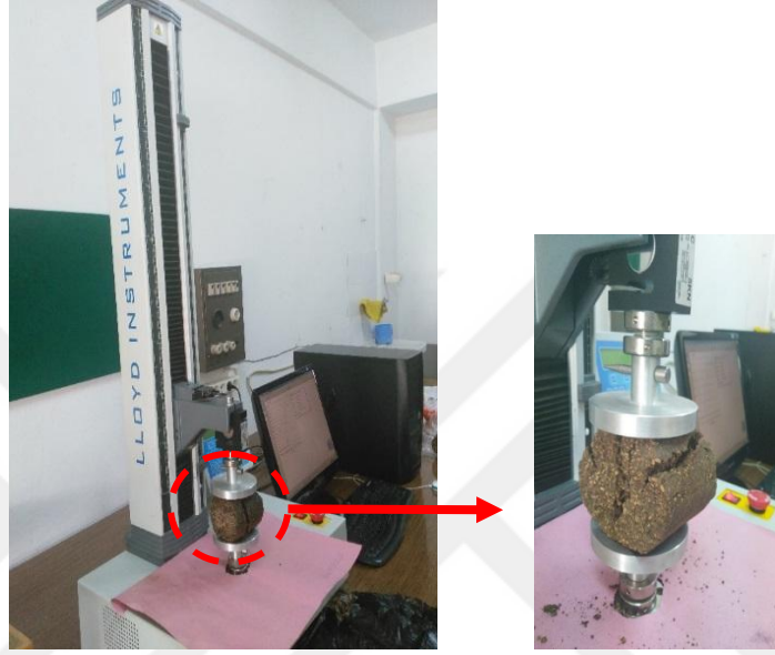
Şekil 4.3. Briket deformasyon testi
