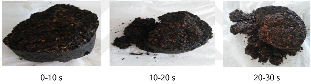
Şekil 4.2. Briket örneklerinin suya daldırıldıktan sonraki görüntüleri
