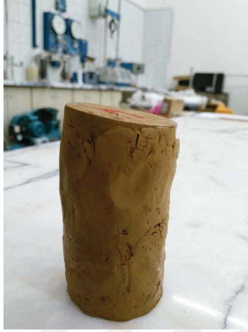
Şekil A.9. Aliğa kiline ait 44 mm \varnothing 88 mm boy %51 su muhtevasında dinamik olarak sıkıştırılarak hazırlanan numuneye ait serbest basınç deneyi sonrası fotoğraf
