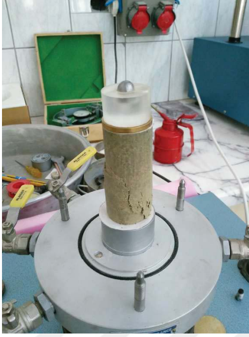
Şekil A.11. Burdur kiline ait 38 mm \varnothing 92 mm boy %22 su muhtevasında dinamik olarak sıkıştırılarak hazırlanan numuneye ait serbest basınç deneyi sonrası fotoğraf
