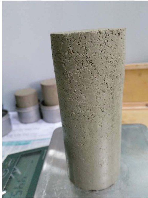
Şekil A.52. İstanbul kiline ait 50 mm çap 126 mm boy %31,8 su muhtevasında statik olarak sıkıştırılarak hazırlanan numuneye ait serbest basınç deneyi sonrası fotoğraf
