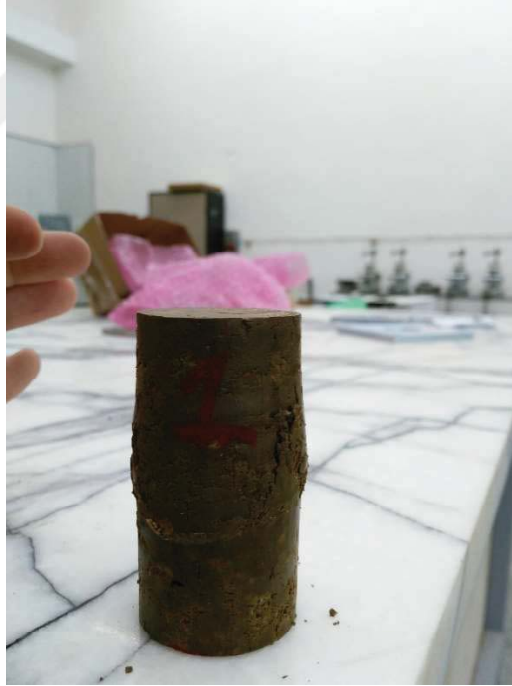
Şekil A.20. Eşen kiline ait 38 mm \varnothing 76 mm boy %31,9 su muhtevasında dinamik olarak sıkıştırılarak hazırlanan numuneye ait serbest basınç deneyi sonrası fotoğraf
