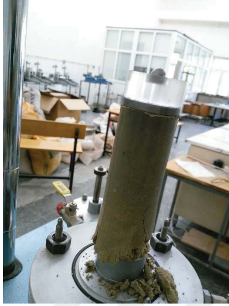
Şekil A.19. Burdur kiline ait 50 mm \varnothing 142 mm boy %22 su muhtevasında dinamik olarak sıkıştırılarak hazırlanan numuneye ait serbest basınç deneyi sonrası fotoğraf
