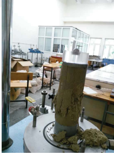
Şekil A.18. Burdur kiline ait 50 mm \varnothing 123 mm boy %22 su muhtevasında dinamik olarak sıkıştırılarak hazırlanan numuneye ait serbest basınç deneyi sonrası fotoğraf
