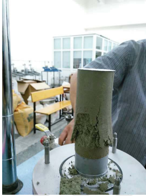
Şekil A.37. Mavi kile ait 50 mm \varnothing 120 mm boy %28 su muhtevasında dinamik olarak sıkıştırılarak hazırlanan numuneye ait serbest basınç deneyi sonrası fotoğraf
