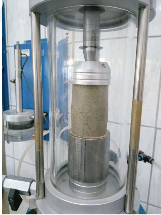
Şekil A.40. İstanbul kiline ait 44 mm çap 66 mm boy %30,5 su muhtevasında statik olarak sıkıştırılarak hazırlanan numuneye ait serbest basınç deneyi sonrası fotoğraf
