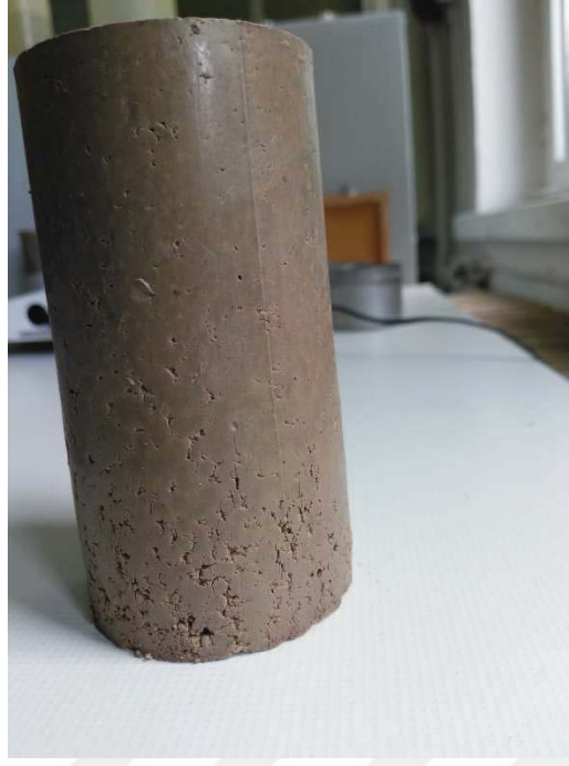
Şekil A.17. Burdur kiline ait 50 mm \varnothing 100 mm boy %23,2 su muhtevasında statik olarak sıkıştırılarak hazırlanan numuneye ait serbest basınç deneyi sonrası fotoğraf
