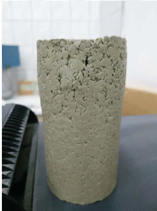
Şekil A.50. İstanbul kiline ait 50 mm çap 101 mm boy %31,3 su muhtevasında statik olarak sıkıştırılarak hazırlanan numuneye ait serbest basınç deneyi sonrası fotoğraf
