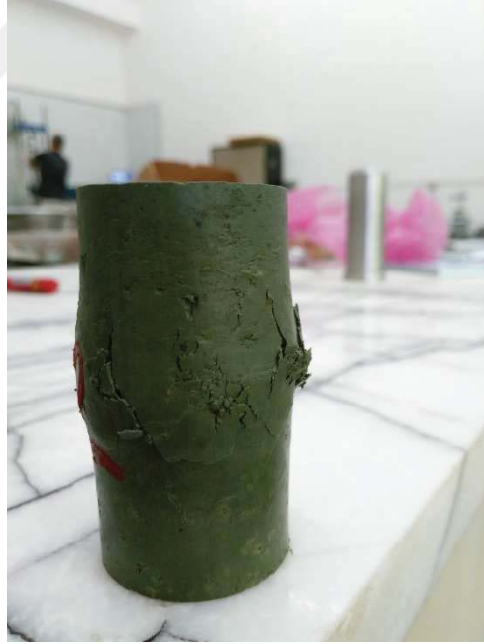
Şekil A.30. Mavi kile ait 38 mm \varnothing 76 mm boy %21,1 su muhtevasında dinamik olarak sıkıştırılarak hazırlanan numuneye ait serbest basınç deneyi sonrası fotoğraf
