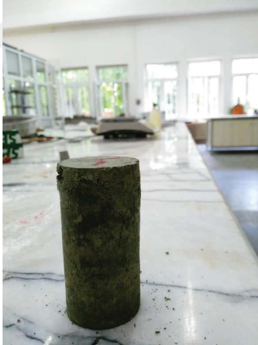
Şekil A.32. Mavi kile ait 44 mm \varnothing 88 mm boy %17,1 su muhtevasında dinamik olarak sıkıştırılarak hazırlanan numuneye ait serbest basınç deneyi sonrası fotoğraf
