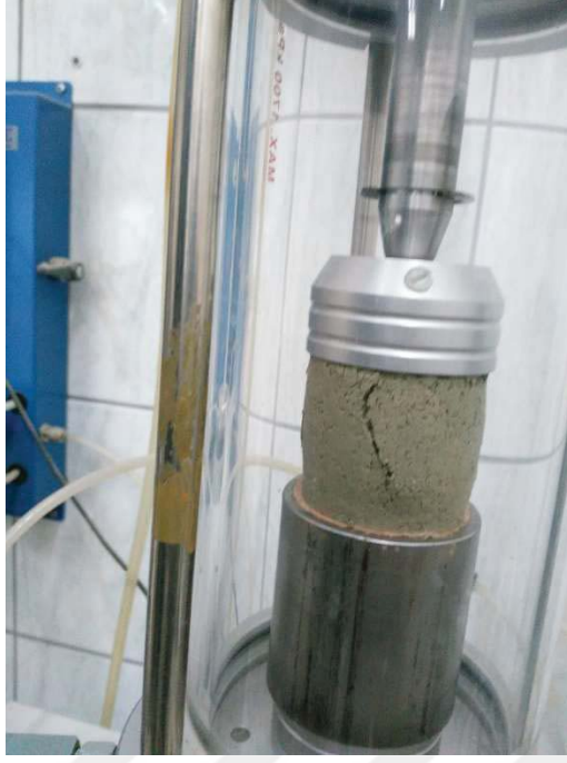
Şekil A.39. İstanbul kiline ait 44 mm çap 44 mm boy %32,7 su muhtevasında statik olarak sıkıştırılarak hazırlanan numuneye ait serbest basınç deneyi sonrası fotoğraf
