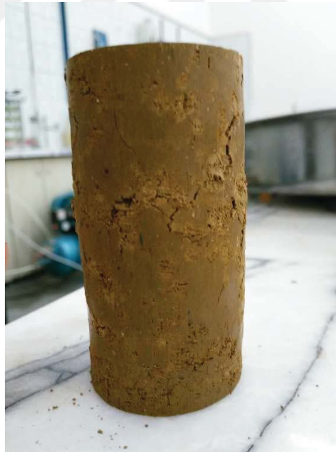
Şekil A.6. Aliğa kiline ait 44 mm \varnothing 88 mm boy %31,4 su muhtevasında dinamik olarak sıkıştırılarak hazırlanan numuneye ait serbest basınç deneyi sonrası fotoğraf
