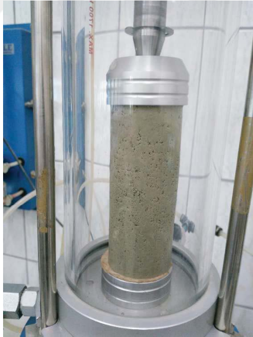
Şekil A.43. İstanbul kiline ait 44 mm çap 88 mm boy %36,2 su muhtevasında statik olarak sıkıştırılarak hazırlanan numuneye ait serbest basınç deneyi sonrası fotoğraf
