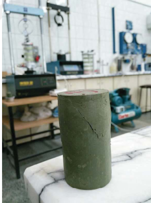
Şekil A.34. Mavi kile ait 44 mm \varnothing 88 mm boy %23,7 su muhtevasında dinamik olarak sıkıştırılarak hazırlanan numuneye ait serbest basınç deneyi sonrası fotoğraf
