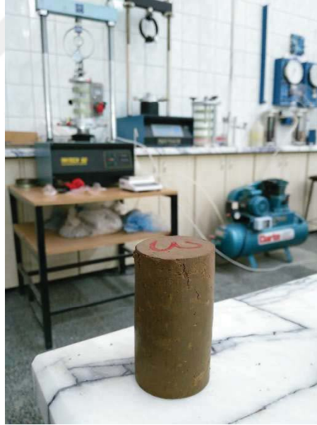
Şekil A.26. Eşen kiline ait 44 mm \varnothing 88 mm boy %34,8 su muhtevasında dinamik olarak sıkıştırılarak hazırlanan numuneye ait serbest basınç deneyi sonrası fotoğraf
