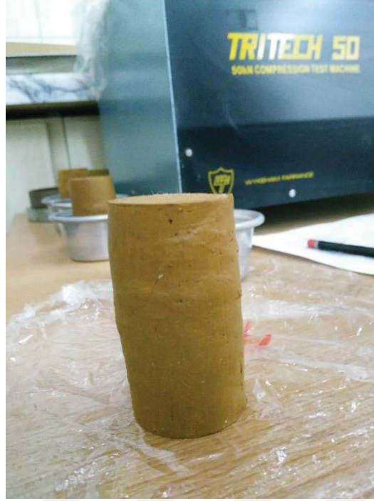
Şekil A.5. Aliğa kiline ait 38 mm \varnothing 76 mm boy %41,8 su muhtevasında dinamik olarak sıkıştırılarak hazırlanan numuneye ait serbest basınç deneyi sonrası fotoğraf
