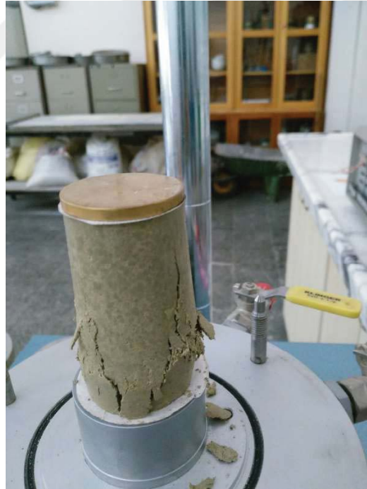
Şekil A.10. Burdur kiline ait 38 mm \varnothing 76 mm boy %22 su muhtevasında dinamik olarak sıkıştırılarak hazırlanan numuneye ait serbest basınç deneyi sonrası fotoğraf
