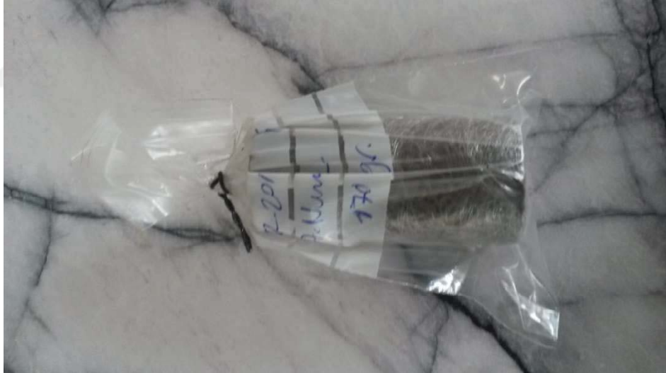
Şekil 4.24. Desikatöre konup 24 saat bekletilmek üzere streçe sarılan bir numune
