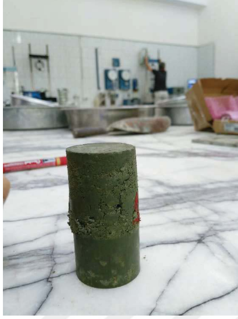
Şekil A.29. Mavi kile ait 38 mm \varnothing 76 mm boy %20 su muhtevasında dinamik olarak sıkıştırılarak hazırlanan numuneye ait serbest basınç deneyi sonrası fotoğraf
