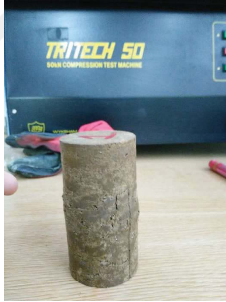
Şekil A.24. Eşen kiline ait 44 mm \varnothing 88 mm boy %29,6 su muhtevasında dinamik olarak sıkıştırılarak hazırlanan numuneye ait serbest basınç deneyi sonrası fotoğraf
