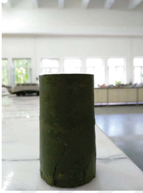
Şekil A.33. Mavi kile ait 44 mm \varnothing 88 mm boy %20,6 su muhtevasında dinamik olarak sıkıştırılarak hazırlanan numuneye ait serbest basınç deneyi sonrası fotoğraf
