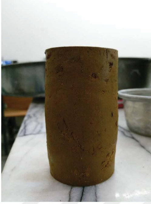
Şekil A.7. Aliğa kiline ait 44 mm çap 88 mm boy %40 su muhtevasında dinamik olarak sıkıştırılarak hazırlanan numuneye ait serbest basınç deneyi sonrası fotoğraf
