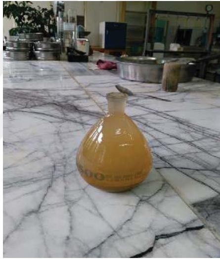
Şekil 4.13. İçerisinde 50 gr zemin numunesi ve saf su cam piknometre şişesi
