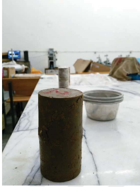
Şekil A.25. Eşen kiline ait 44 mm \varnothing 88 mm boy %31,8 su muhtevasında dinamik olarak sıkıştırılarak hazırlanan numuneye ait serbest basınç deneyi sonrası fotoğraf
