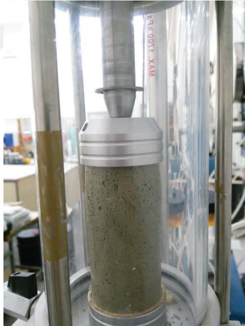
Şekil A.42. İstanbul kiline ait 44 mm \varnothing 87 mm boy %33,7 su muhtevasında statik olarak sıkıştırılarak hazırlanan numuneye ait serbest basınç deneyi sonrası fotoğraf
