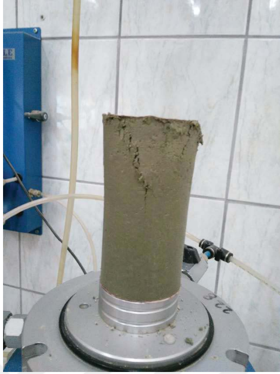
Şekil A.51. İstanbul kiline ait 50 mm çap 102 mm boy %25,7 su muhtevasında statik olarak sıkıştırılarak hazırlanan numuneye ait serbest basınç deneyi sonrası fotoğraf
