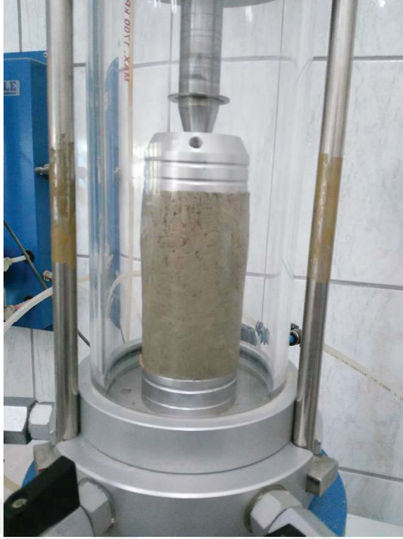
Şekil A.47. İstanbul kiline ait 50 mm çap 92 mm boy %33,7 su muhtevasında statik olarak sıkıştırılarak hazırlanan numuneye ait serbest basınç deneyi sonrası fotoğraf
