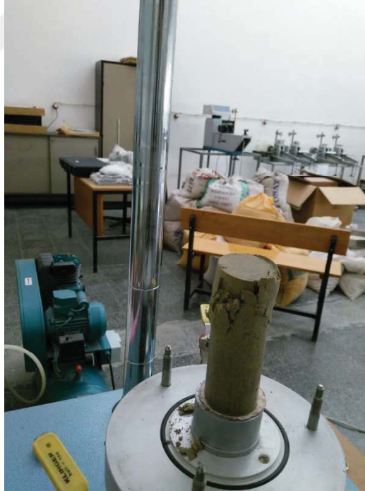
Şekil A.12. Burdur kiline ait 38 mm \varnothing 107 mm boy %22 su muhtevasında dinamik olarak sıkıştırılarak hazırlanan numuneye ait serbest basınç deneyi sonrası fotoğraf
