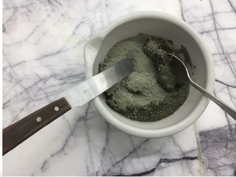
Şekil 4.20. İstenilen miktarda zemin ve suyun porselen kapta karıştırılması
