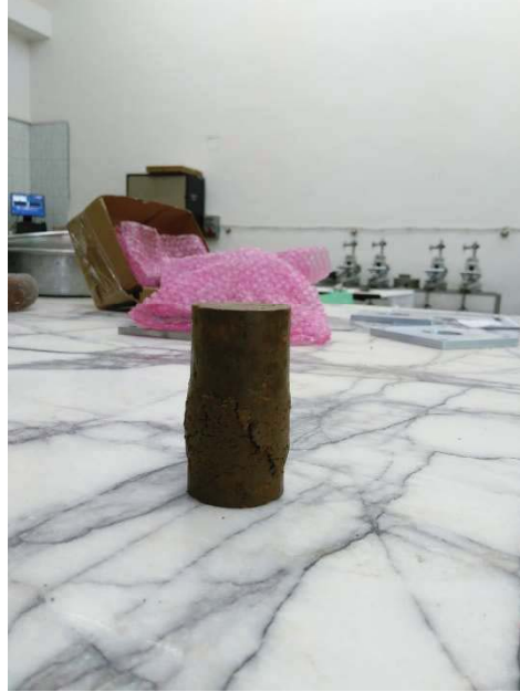
Şekil A.22. Eşen kiline ait 38 mm \varnothing 76 mm boy %36 su muhtevasında dinamik olarak sıkıştırılarak hazırlanan numuneye ait serbest basınç deneyi sonrası fotoğraf
