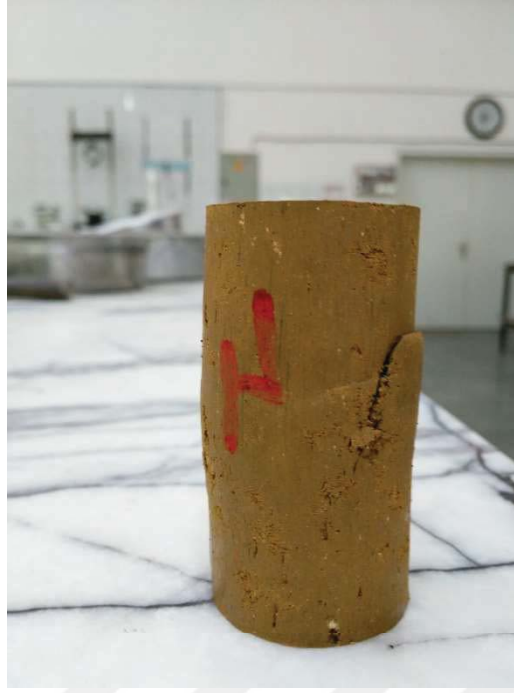
Şekil A.3. Aliğa kiline ait 38 mm \varnothing 76 mm boy %35,7 su muhtevasında dinamik olarak sıkıştırılarak hazırlanan numuneye ait serbest basınç deneyi sonrası fotoğraf
