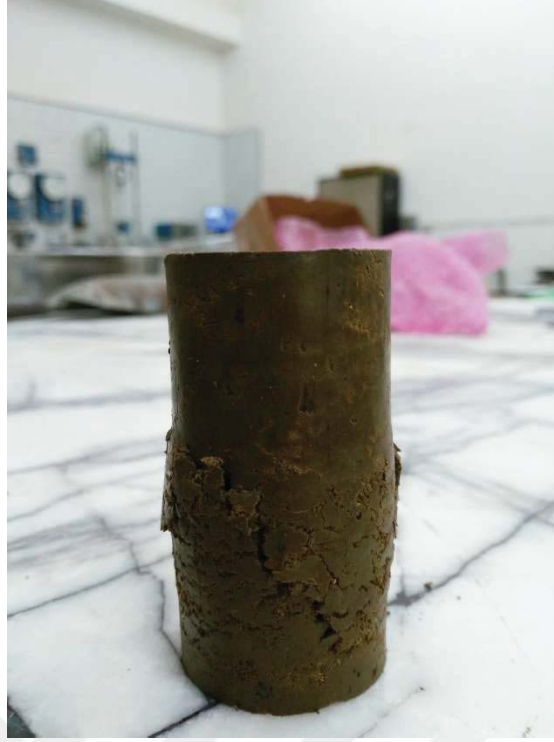
Şekil A.21. Eşen kiline ait 38 mm \varnothing 76 mm boy %34,2 su muhtevasında dinamik olarak sıkıştırılarak hazırlanan numuneye ait serbest basınç deneyi sonrası fotoğraf
