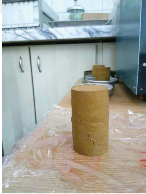
Şekil A.4. Aliğa kiline ait 38 mm \varnothing 76 mm boy %39 su muhtevasında dinamik olarak sıkıştırılarak hazırlanan numuneye ait serbest basınç deneyi sonrası fotoğraf
