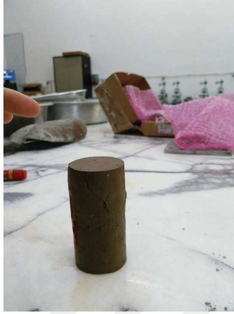
Şekil A.23. Eşen kiline ait 38 mm \varnothing 76 mm boy %39 su muhtevasında dinamik olarak sıkıştırılarak hazırlanan numuneye ait serbest basınç deneyi sonrası fotoğraf
