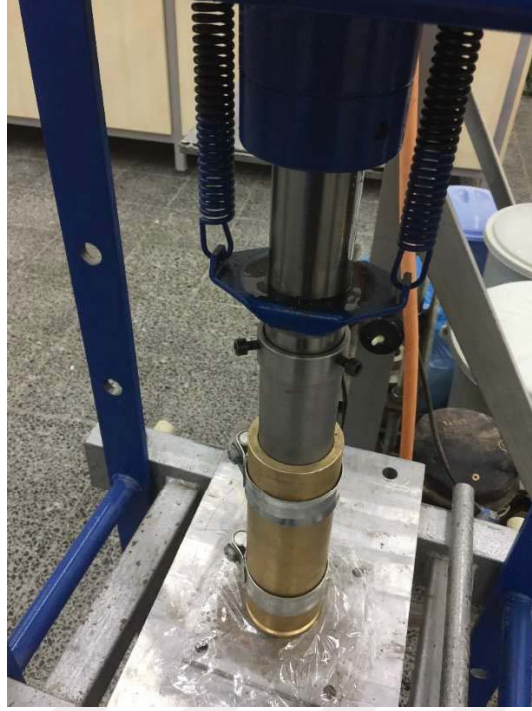
Şekil 4.23. Sıkıştırılan numunelerin kalıptan dışarı ittirilerek çıkarılması
