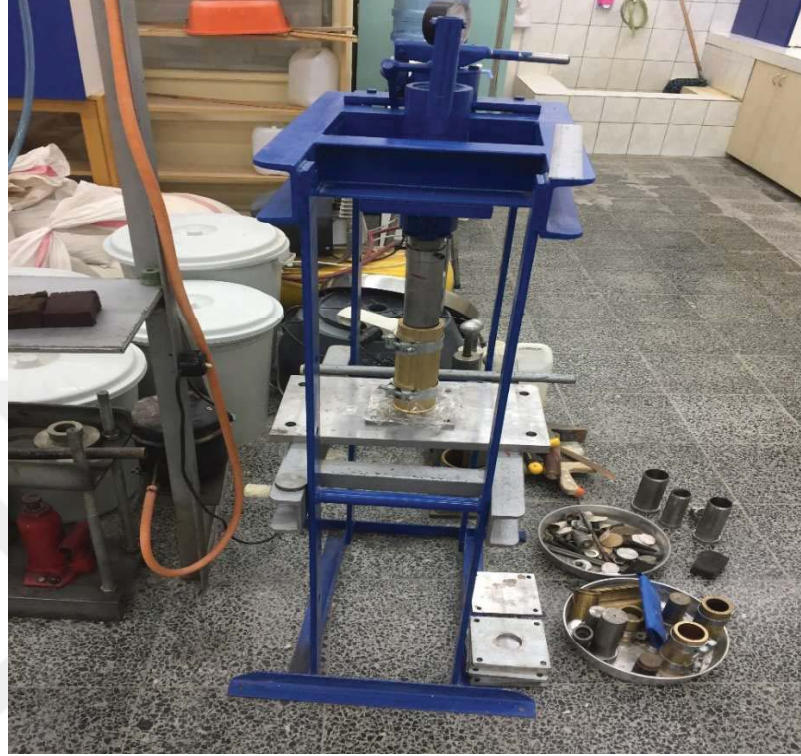
Şekil 4.22. Kalıplar ierisine doldurulan numunelerin istenilen boyda statik olarak sıkıştırılması
