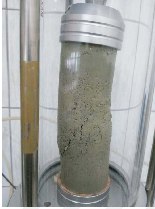
Şekil A.45. İstanbul kiline ait 44 mm çap 122 mm boy %32,5 su muhtevasında statik olarak sıkıştırılarak hazırlanan numuneye ait serbest basınç deneyi sonrası fotoğraf
