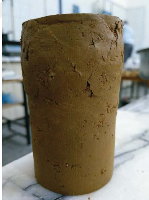
Şekil A.8. Aliğa kiline ait 44 mm çap 88 mm boy %48 su muhtevasında dinamik olarak sıkıştırılarak hazırlanan numuneye ait serbest basınç deneyi sonrası fotoğraf
