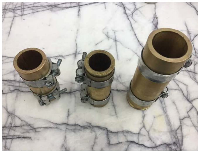
Şekil 4.21. Pirinçten imal ettirilen 38 mm, 44 mm ve 50 mm çapında kalıplar
