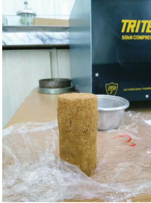
Şekil A.1. Aliğa kiline ait 38 mm çap 76 mm boy %27 su muhtevasında dinamik olarak sıkıştırılarak hazırlanan numuneye ait serbest basınç deneyi sonrası fotoğraf
