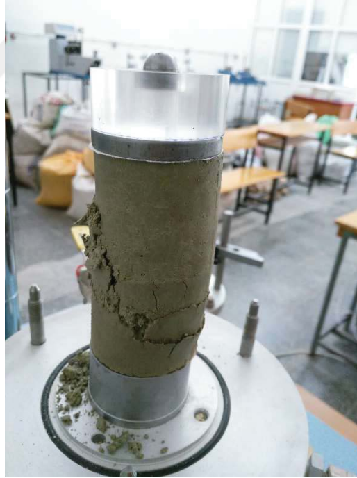
Şekil A.36. Mavi kile ait 50 mm çap 100 mm boy %28 su muhtevasında dinamik olarak sıkıştırılarak hazırlanan numuneye ait serbest basınç deneyi sonrası fotoğraf
