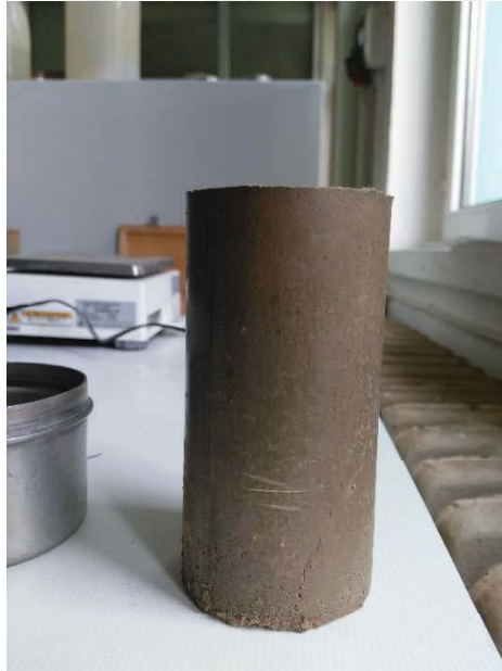
Şekil A.16. Burdur kiline ait 50 mm \varnothing 100 mm boy %22,3 su muhtevasında statik olarak sıkıştırılarak hazırlanan numuneye ait serbest basınç deneyi sonrası fotoğraf
