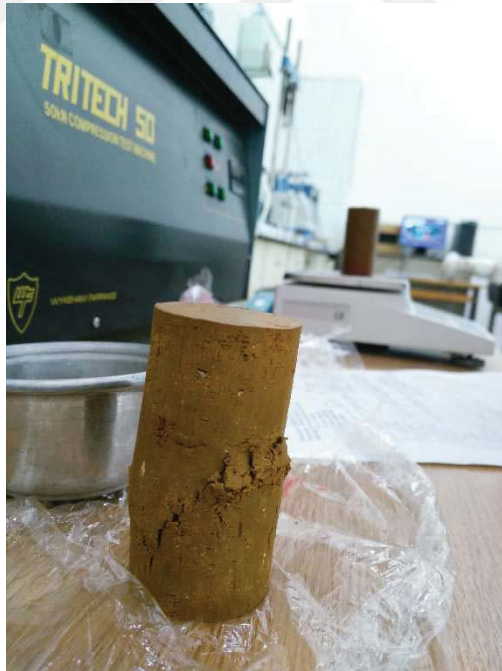
Şekil A.2. Aliğa kiline ait 38 mm çap 76 mm boy %33 su muhtevasında dinamik olarak sıkıştırılarak hazırlanan numuneye ait serbest basınç deneyi sonrası fotoğraf
