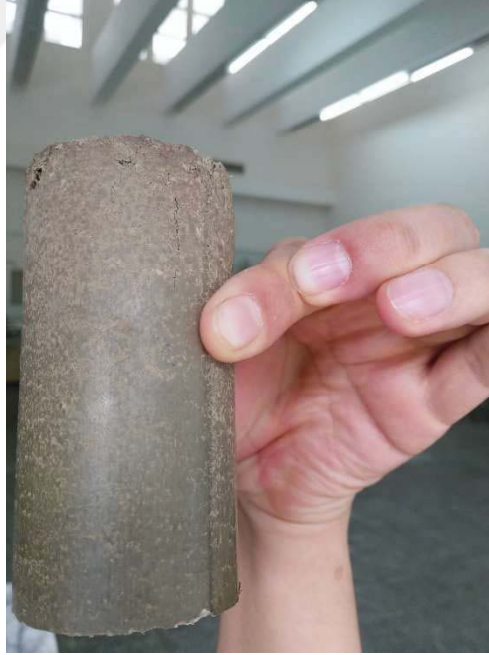
Şekil A.14. Burdur kiline ait 50 mm \varnothing 100 mm boy %18,6 su muhtevasında statik olarak sıkıştırılarak hazırlanan numuneye ait serbest basınç deneyi sonrası fotoğraf
