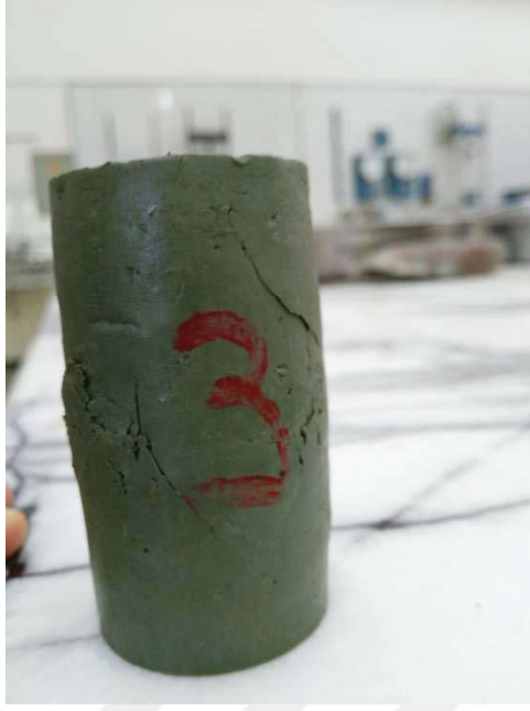
Şekil A.31. Mavi kile ait 38 mm \varnothing 76 mm boy %24 su muhtevasında dinamik olarak sıkıştırılarak hazırlanan numuneye ait serbest basınç deneyi sonrası fotoğraf
