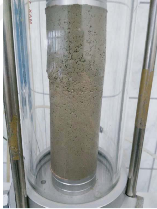
Şekil A.46. İstanbul kiline ait 44 mm çap 151 mm boy %31,8 su muhtevasında statik olarak sıkıştırılarak hazırlanan numuneye ait serbest basınç deneyi sonrası fotoğraf
