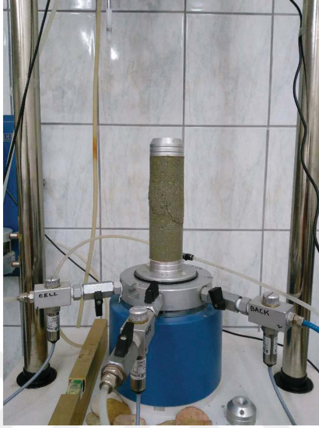
Şekil A.53. İstanbul kiline ait 50 mm çap 151 mm boy %24 su muhtevasında statik olarak sıkıştırılarak hazırlanan numuneye ait serbest basınç deneyi sonrası fotoğraf
