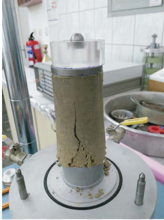
Şekil A.15. Burdur kiline ait 50 mm \varnothing 100 mm boy %22 su muhtevasında dinamik olarak sıkıştırılarak hazırlanan numuneye ait serbest basınç deneyi sonrası fotoğraf
