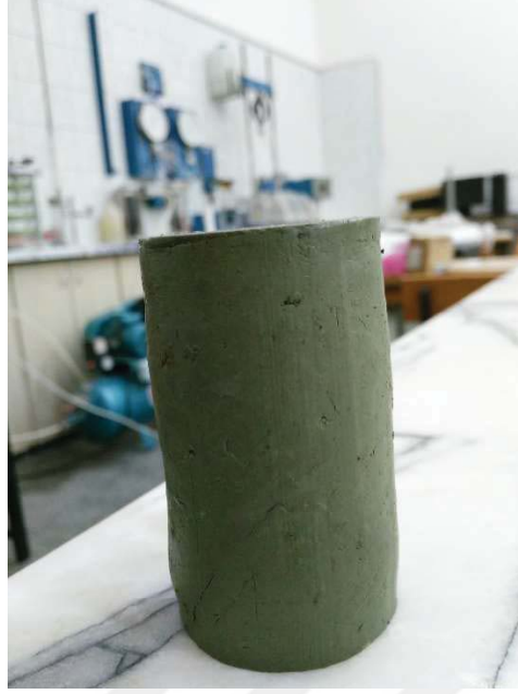
Şekil A.35. Mavi kile ait 44 mm çap 88 mm boy %24,3 su muhtevasında dinamik olarak sıkıştırılarak hazırlanan numuneye ait serbest basınç deneyi sonrası fotoğraf
