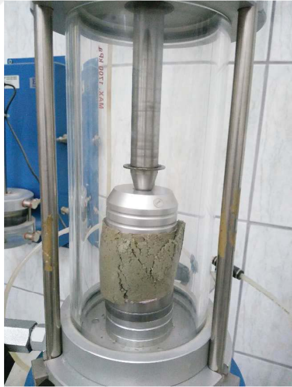
Şekil A.48. İstanbul kiline ait 50 mm çap 51 mm boy %31,6 su muhtevasında statik olarak sıkıştırılarak hazırlanan numuneye ait serbest basınç deneyi sonrası fotoğraf
