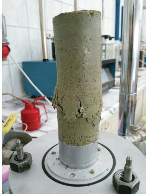
Şekil A.38. Mavi kile ait 50 mm \varnothing 143 mm boy %28 su muhtevasında dinamik olarak sıkıştırılarak hazırlanan numuneye ait serbest basınç deneyi sonrası fotoğraf
