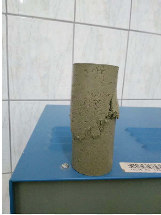
Şekil A.43. İstanbul kiline ait 44 mm çap 88 mm boy %36,2 su muhtevasında statik olarak sıkıştırılarak hazırlanan numuneye ait serbest basınç deneyi sonrası fotoğraf
