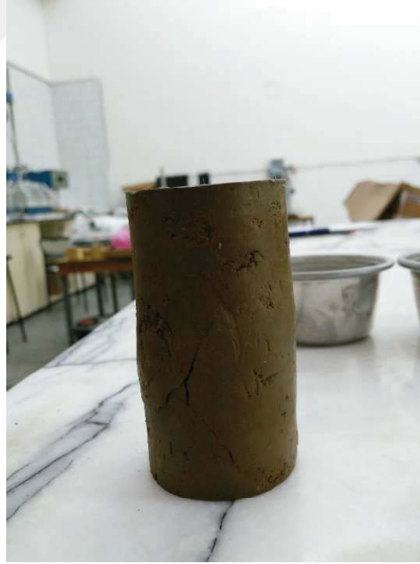
Şekil A.28. Eşen kiline ait 44 mm çap 88 mm boy %46,6 su muhtevasında dinamik olarak sıkıştırılarak hazırlanan numuneye ait serbest basınç deneyi sonrası fotoğraf
