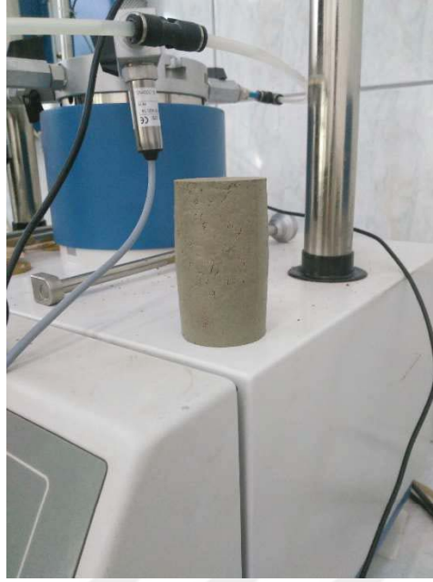
Şekil A.41. İstanbul kiline ait 44 mm \varnothing 86 mm boy %30,5 su muhtevasında statik olarak sıkıştırılarak hazırlanan numuneye ait serbest basınç deneyi sonrası fotoğraf
