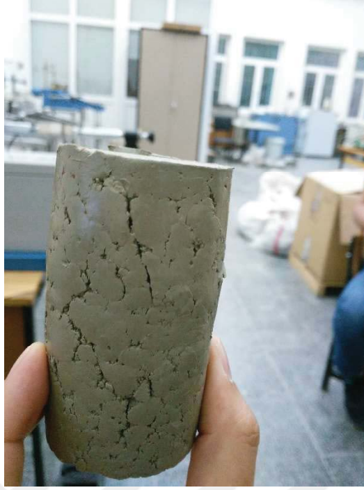
Şekil A.49. İstanbul kiline ait 50 mm çap 100 mm boy %34,1 su muhtevasında statik olarak sıkıştırılarak hazırlanan numuneye ait serbest basınç deneyi sonrası fotoğraf
