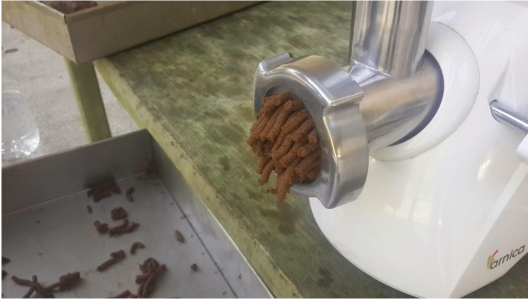
Şekil 2.2. Hamur haldeki yem materyalinin kıyma makinesinden geçirilerek pelet haline getirilmesi
