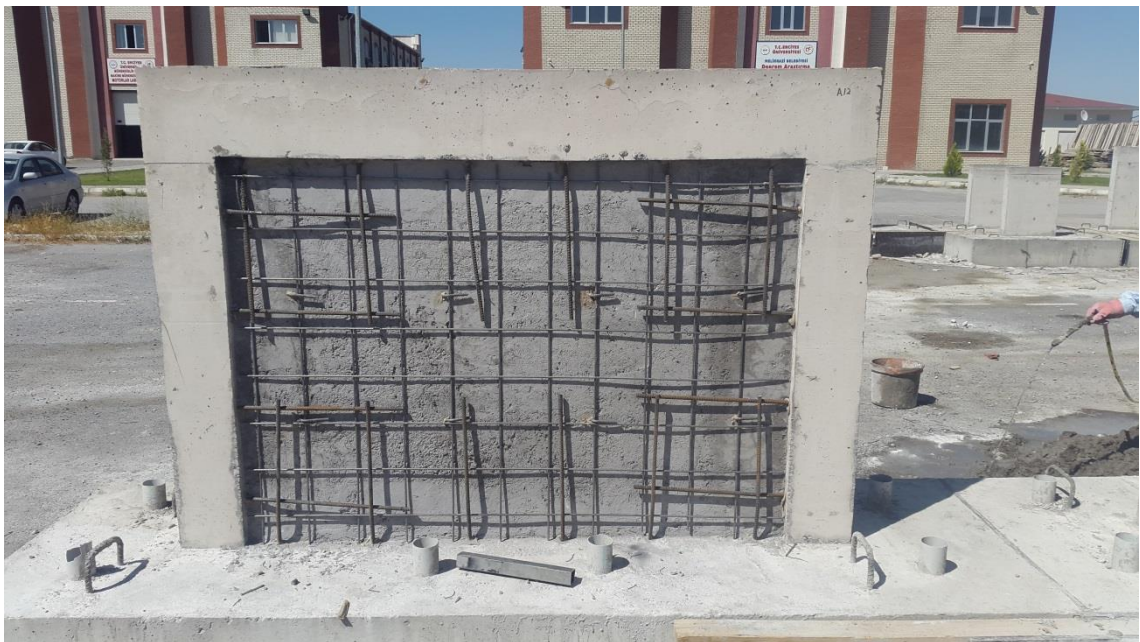
Şekil 3.25. 5 no'lu numune ankraj detayları
