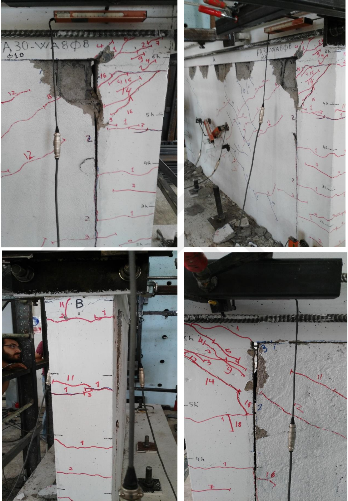
Şekil 4. 24: 20. döngü sonunda çatlak, ayrılma ve dökülme durumu.
