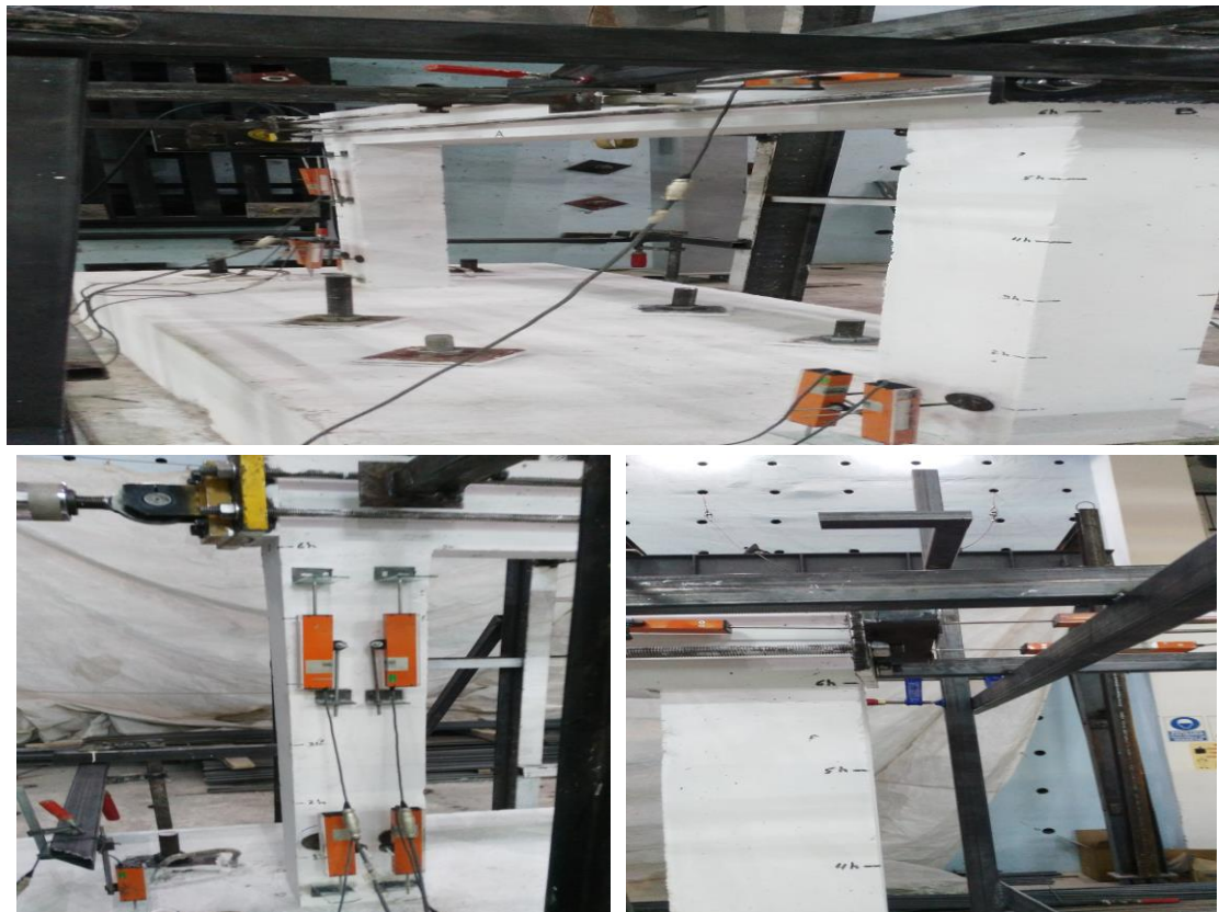
řekil 3. 31: LVDT lerle numuneden veri toplanması
