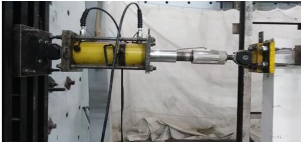
Şekil 3. 28: Yükleme düzeneği, kriko ve yük hücresi.
