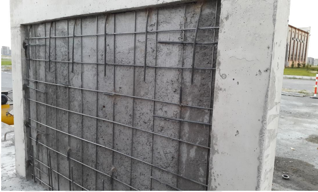
Şekil 3. 24. 4 no'lu numune ankraj detayları
