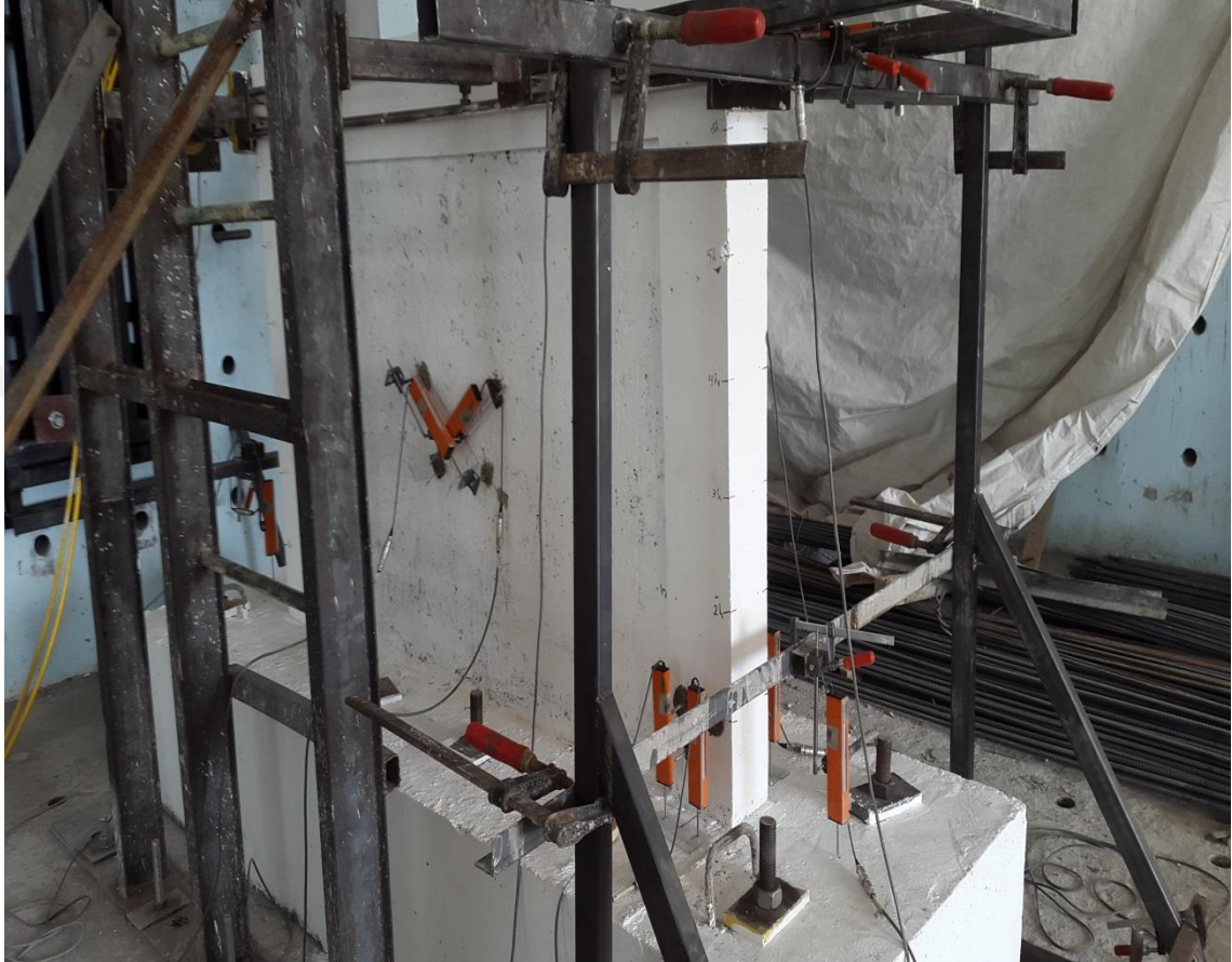
Şekil 3.32. Dolgu duvarlı numunesine yatay yükleme yapılması
