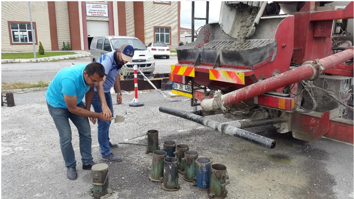
Şekil 3.9. Beton numunelerinin alınması
