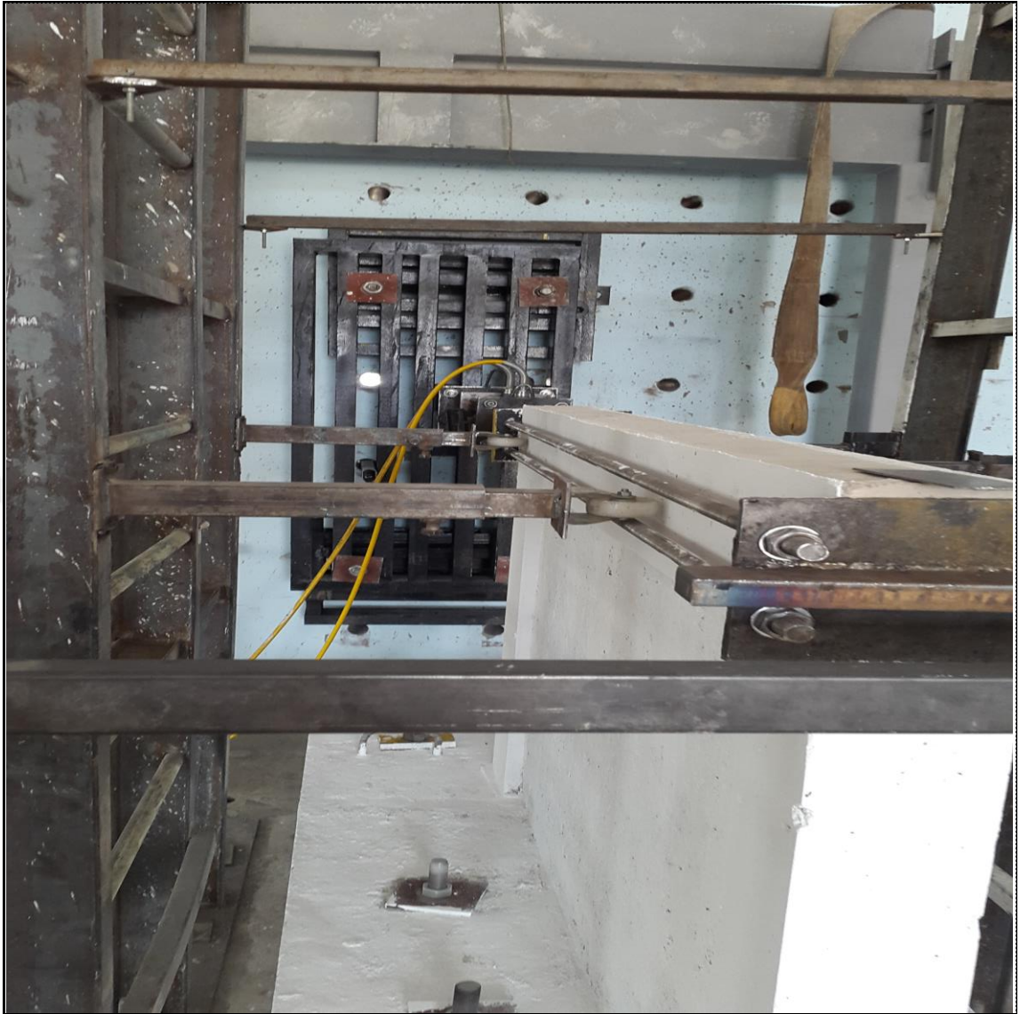
Şekil 3. 26: Düzlem dışı hareketi engellemek için yapılan kayıcı mesnetler
