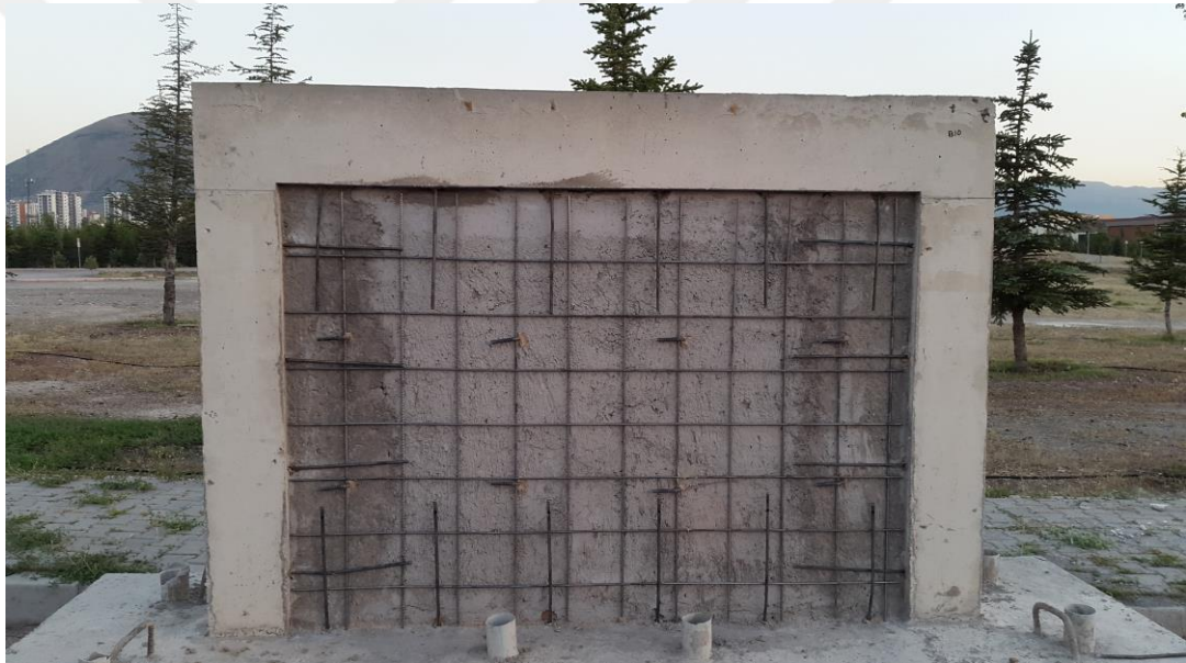
Şekil 3. 23:3 no’lu numune ankraj detayları
