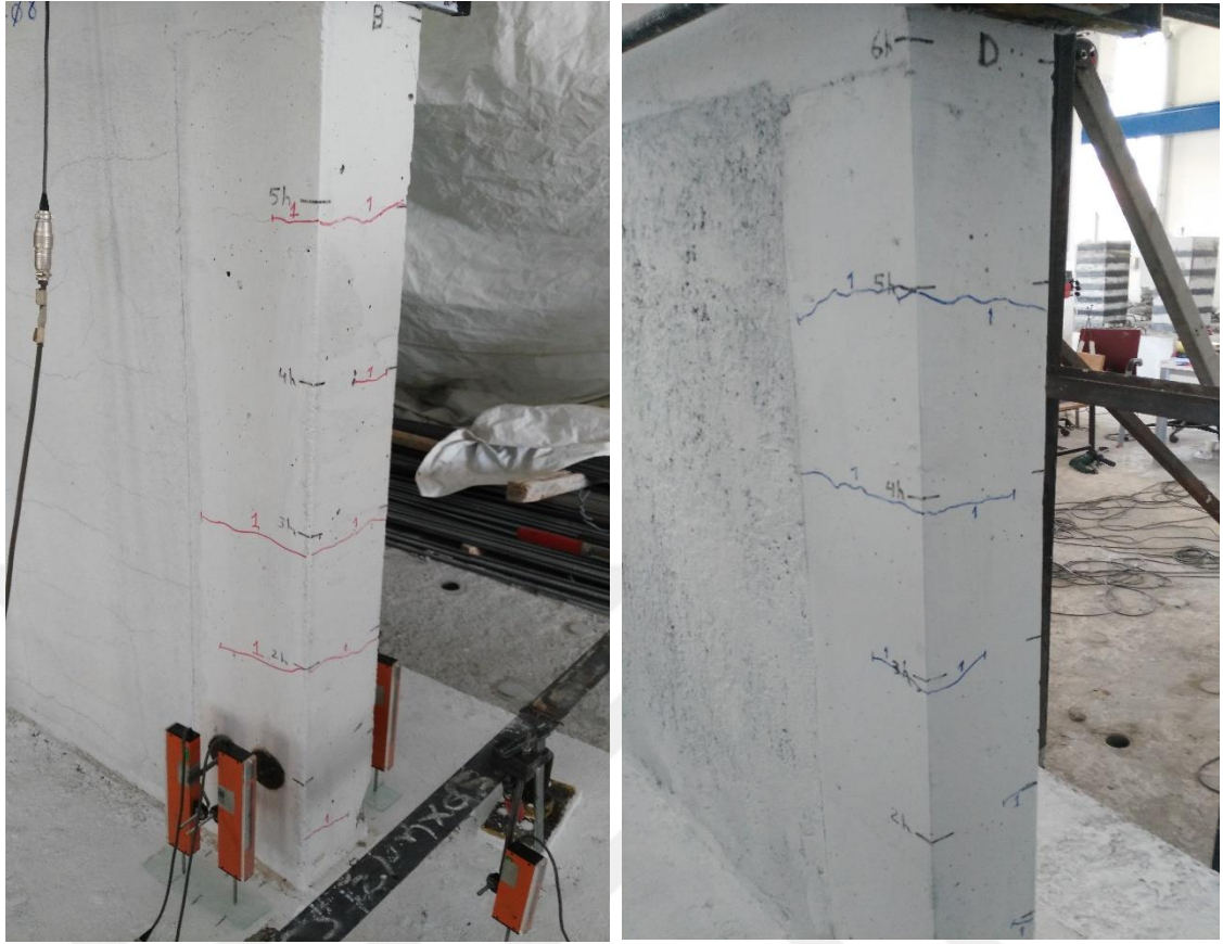
Şekil 4.14. 1. döngü sonunda oluşan çatlaklar.
