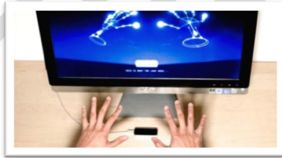
Şekil 2-6. Leap Motion cihazı ile hareket algılama (89)
