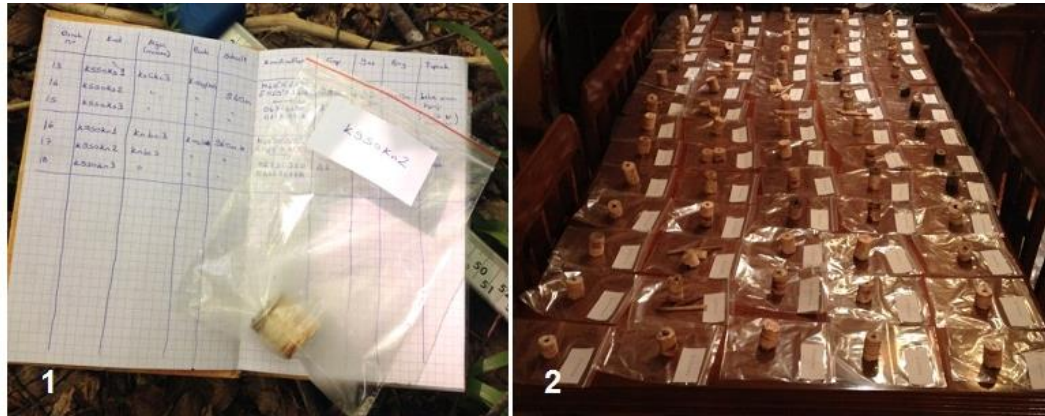
Şekil 3.14: Örneklerin etiketlenmesi, arazi defterine kaydedilmesi (1) ve kurutulması (2).
