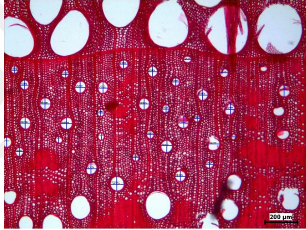
Şekil 3.27: Halkalı traheli Quercus cerris türünün yaz odunu enine kesitinde trahe teğet ve radyal lümen çaplarının ölçümü.
