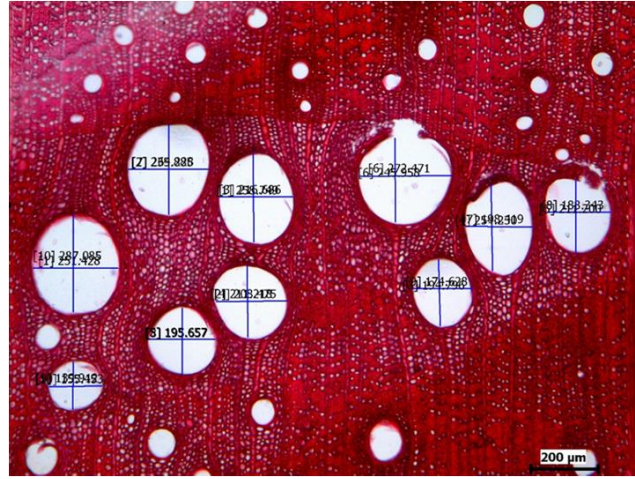
Şekil 3.26: Halkalı traheli Quercus cerris türünün ilkbahar odunu enine kesitinde trahe teğet ve radyal lümen çaplarının ölçümü.
