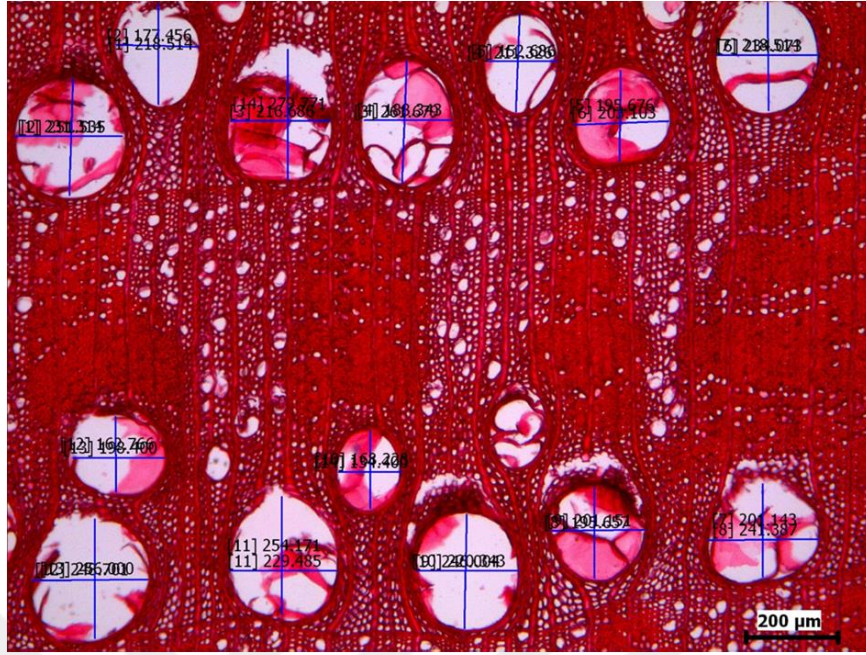
Şekil 3.24: Halkalı traheli Quercus petraea türünün ilkbahar odunu enine kesitinde trahe teğet ve radyal lümen çaplarının ölçümü.
