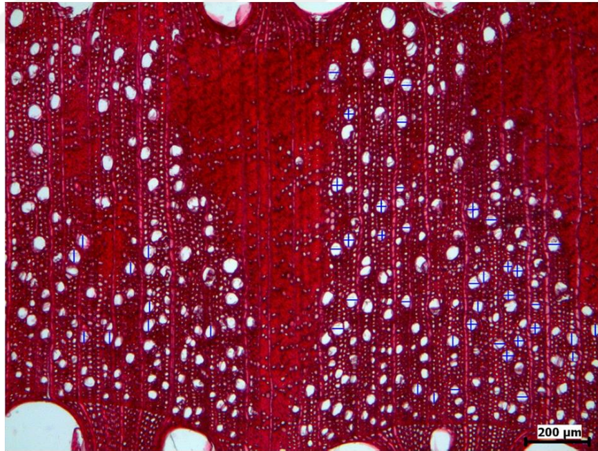
Şekil 3.25: Halkalı traheli Quercus petraea türünün yaz odunu enine kesitinde trahe teğet ve radyal lümen çaplarının ölçümü.
