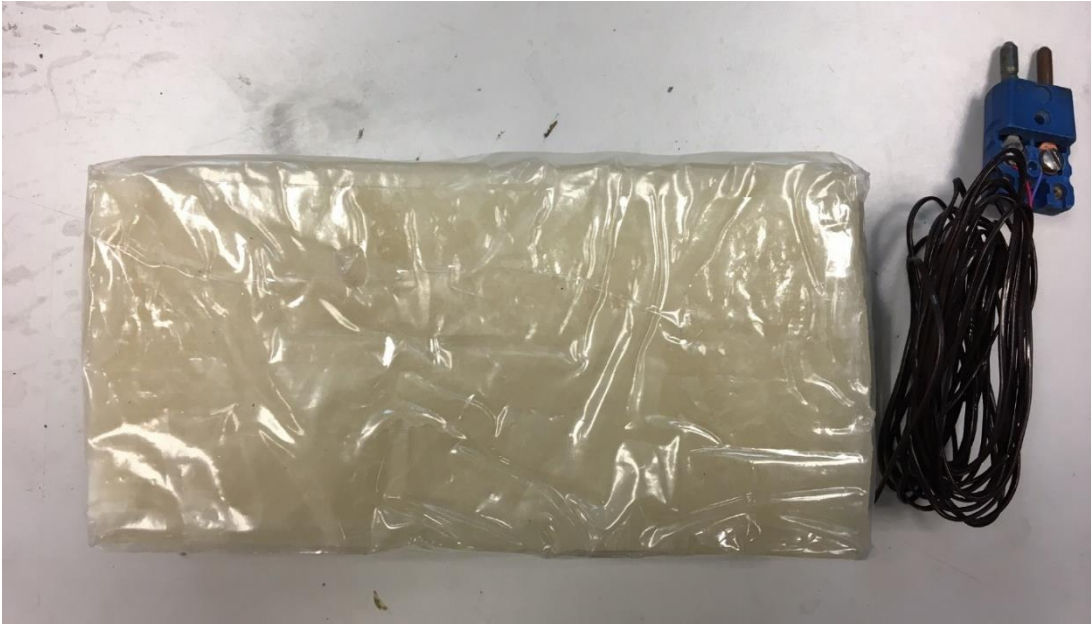
Şekil 3.7 : Etil-Metil Selüloz bileşimli yük paketi.
