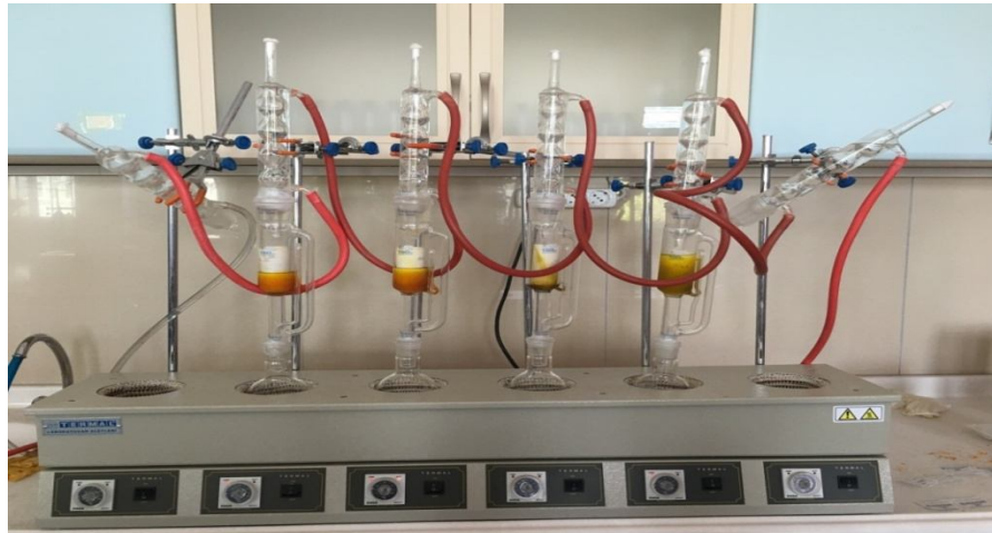
Şekil 3.14. Aynısefa çiçeklerinin soxhlet düzeneğinde sabit yağ miktarının belirlenmesi
