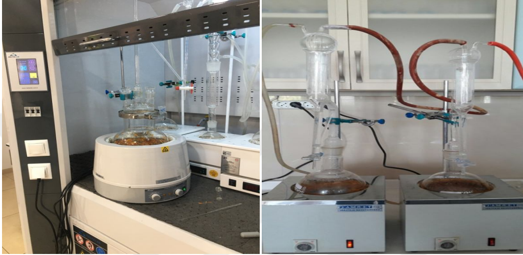
Şekil 3.13. Aynısefa ( Calendula officinalis L.)'nın çiçeklerinden clevenger apereyi ile uçucu yağlarının elde edilmesi
