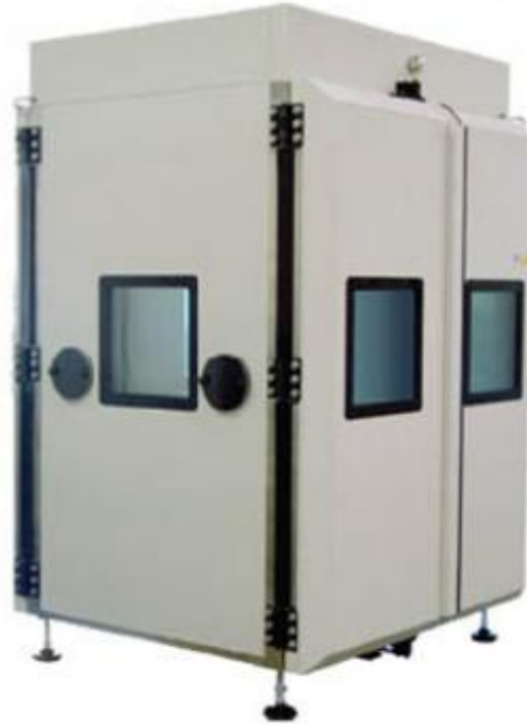
Şekil 2.2 : HALT yöntemi için iklimlendirme kabini
