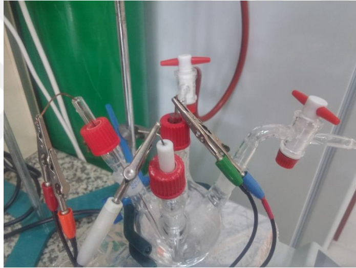
Şekil 2.5. Çalışma hücresinin hazırlanması ve elektrotların bağlanması.
