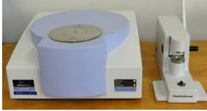
Şekil 3.8. Diferansiyel taramalı kalorimetre cihazı PerkinElmer DSC-4000
