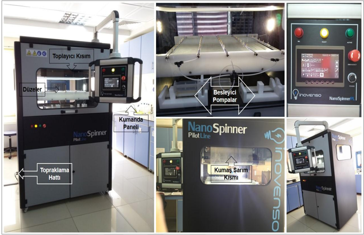
Şekil 3.2. Yarı endüstriyel çok iğneli elektro çekim cihazı (Yıldırım, 2016)
