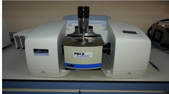
Şekil 3. 4. Fourier transform infra-red spektrometre (FTIR) cihazı Perkin Elmer Spectrum 400 FTIR model
