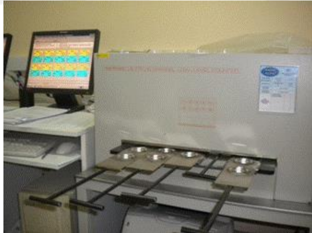
Şekil 3.28: ÇNAEM Radyoaktivite Ölçme ve Analiz Birimi Toplam Alfa ve Toplam Beta Laboratuvarı Berthold marka LB770-PC model 10-kanallı düşük seviyeli planşet sayıcısı.
