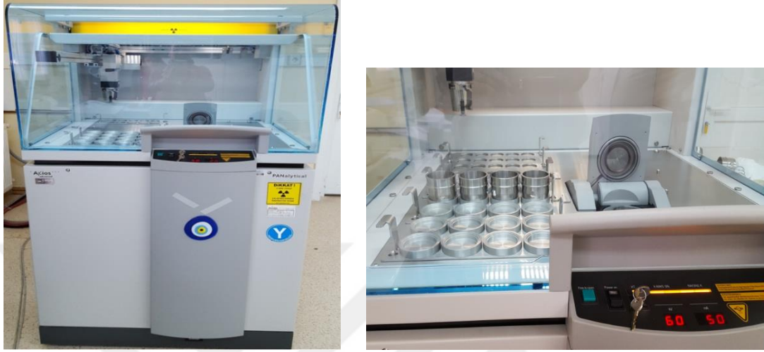
Şekil 3.18: PANalytical Axios mAX marka Advanced model WDXRF Spektrometre cihazı.
