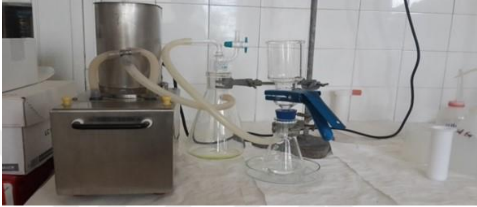
Şekil 3.58: Çözünürleştirmeden sonra numunelerin filtreden geçirilme düzeneği.
