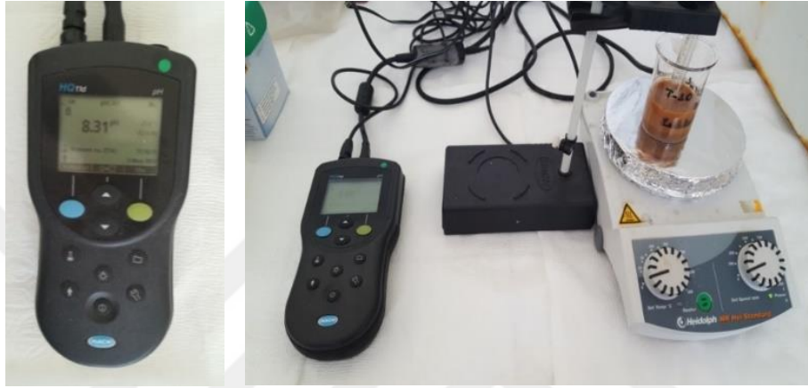
Şekil 3.69: pH metre ve toprak numunesinde pH ölçüm düzeneği.
