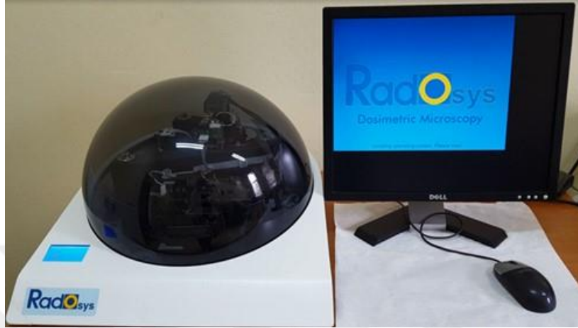
Şekil 3.64: RadoSys otomatik iz sayım sistemi (ÇNAEM Sağlık Fiziği Bölümü Radyasyon Ölçme ve Kontrol Birimi Radon Sayım Laboratuvarı).
