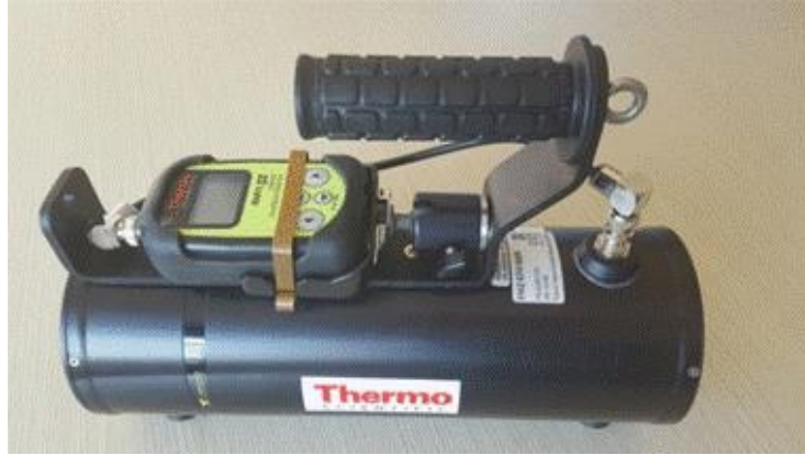
Şekil 3.4: FHZ 674 NBR model sintilasyon dedektörüne uyumlu Thermo Scientific RadEye SX marka taşınabilir dijital radyasyon ölçüm cihazı.
