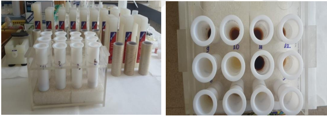
Şekil 3.57: XP-1500 model teflon kaplar ve içerisindeki numunelere ultra saf su ve asit karışımı ilave edilmiş görüntüsü.
