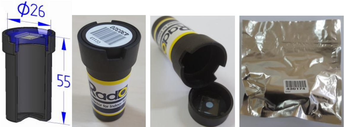
Şekil 3.60: Radon dedektörünün boyutları, kapağa sabitlenmiş CR-39 plastik pasif iz dedektörü ve radon dedektörünün folyolanmış görüntüsü.
