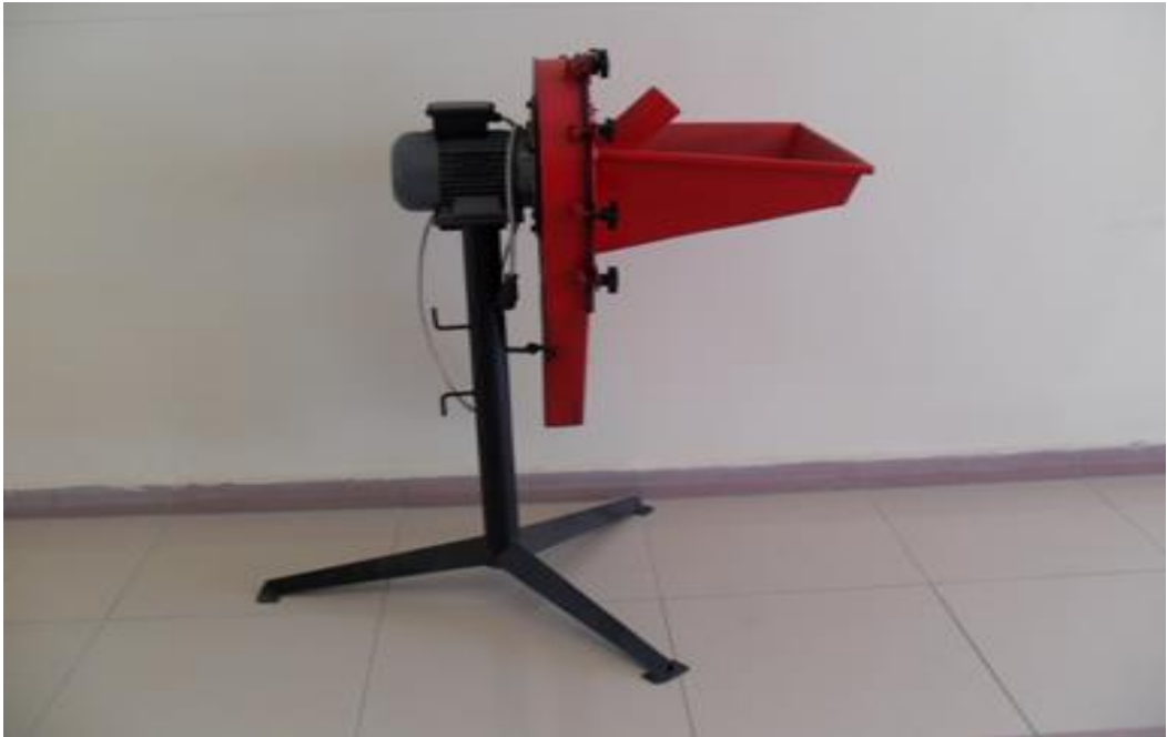
Şekil 3.2. Pamuk diken öğütülmesinde kullanılan öğütme makinesi
