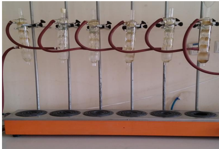
Şekil 3.7. Pamuk dikeninin ham yağ içeriğini belirlemede kullanılan Soxhlet cihazı
