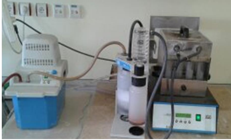
Şekil 3.4. Pamuk dikeninin ham proteininde analizinde kullanılan yağ yakma ünitesi
