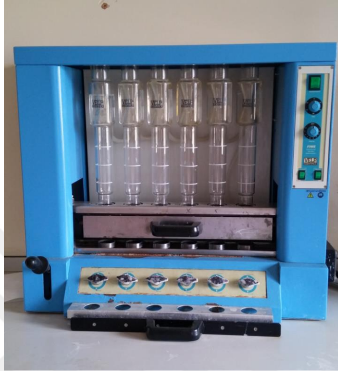
Şekil 3.6. Pamuk dikeninin ADF ve NDF içeriğini belirlemede kullanılan cihaz
