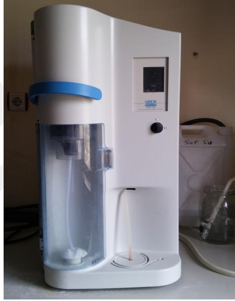
Şekil 3.5. Pamuk dikeninin ham proteininde analizinde kullanılan destilasyon cihazı
