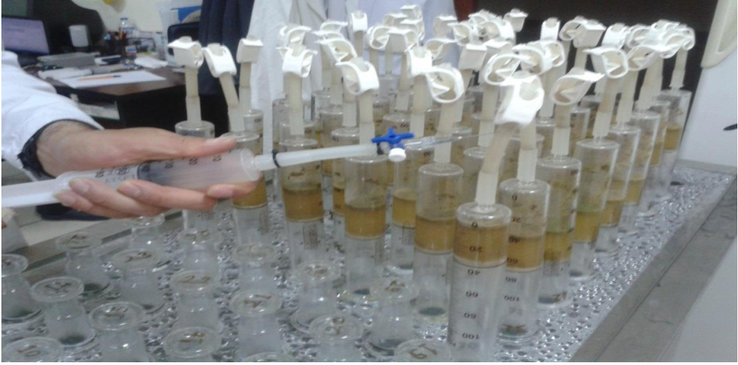
Şekil 3.8. Pamuk dikenin gaz ve metan üretimini belirlemede kullanılan gaz ölçüm seti
