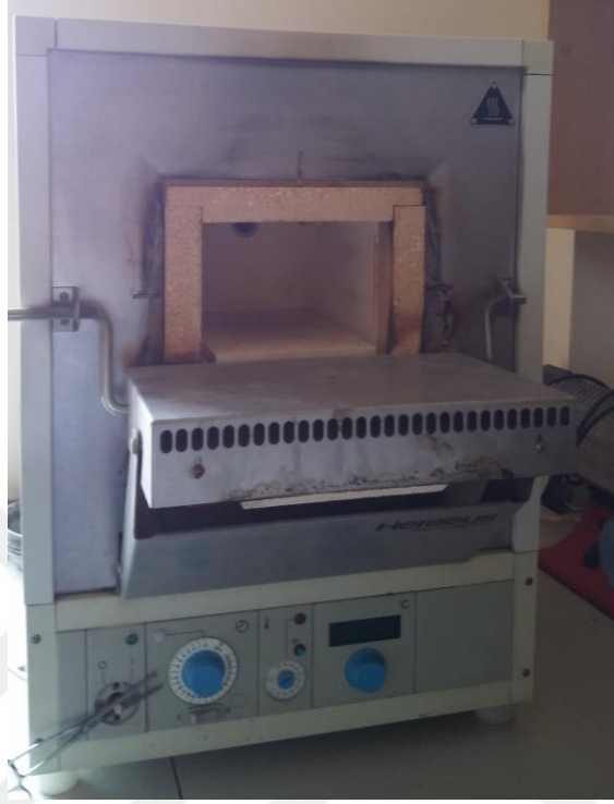
Şekil 3.3. Pamuk dikenin ham kül içeriğini kullanılmasıda kullanılan kül fırını
