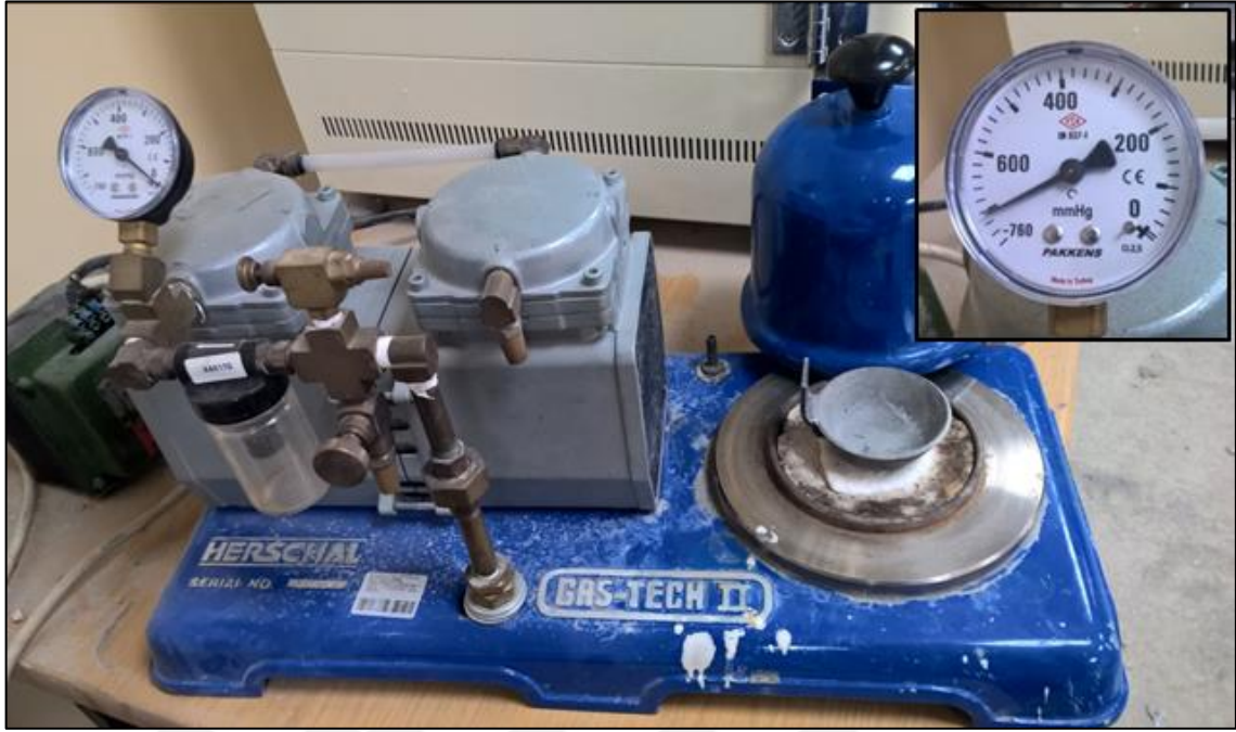
Şekil 3.2: RPT test cihazı ve çalışma sırasındaki vakum değeri (sağ üst).
