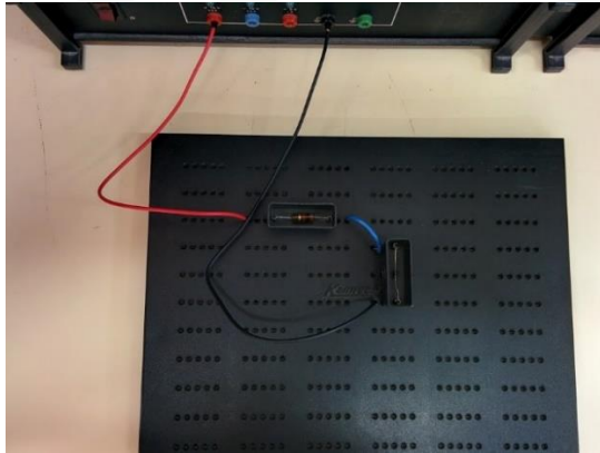
Şekil 4.19. Diyot deneyinin delikli devre montaj panelindeki yerleşimi
