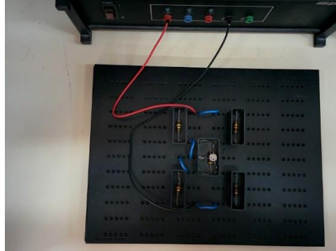
Şekil 4.22. BJT gerilim bölücü polarma devresi deneyinin delikli devre montaj panelindeki yerleşimi
