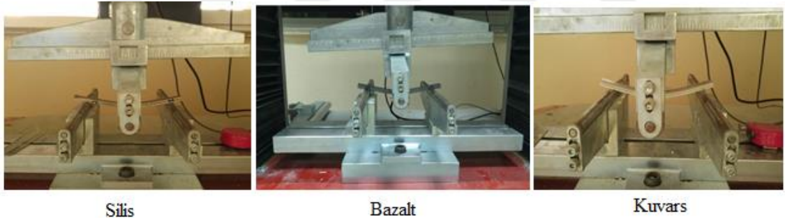
Şekil 3.42. Eğilme testlerine tabi tutulan lifli kompozitler.
