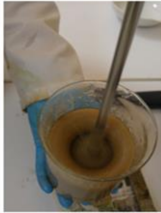
Reçine ve dolgu malzemesinin homojen karışımı
