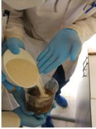
Dolgu malzemesinin reçine içerisine dökülmesi
