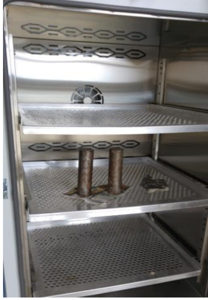
Şekil 3.25. Kalıp içerisinde jelleşen karışımların post kür işlemi.
