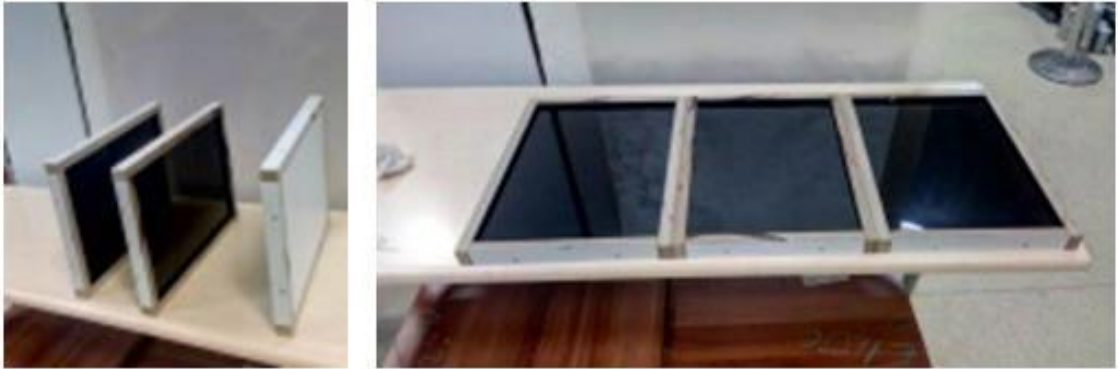
Şekil 3.32. Kompozit levha üretiminde kullanılan kalıplar.
