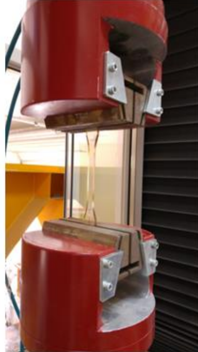
Şekil 3.19. Reçine karışımlarının kaşık çekme dayanımı testi.
