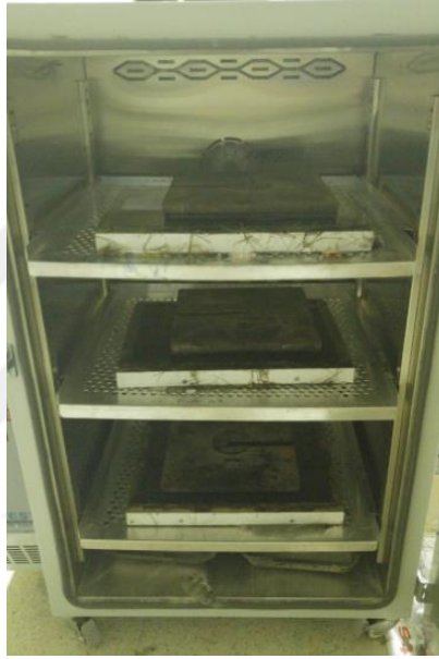
Şekil 3.35. Kalıp içerisinde jelleşen karışımların post kür edilmesi işlemi.
