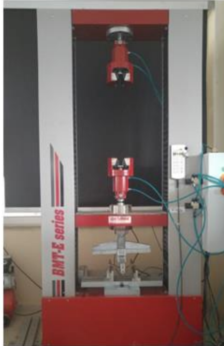
Şekil 3.19. Reçine karışımlarının kaşık çekme dayanımı testi.
