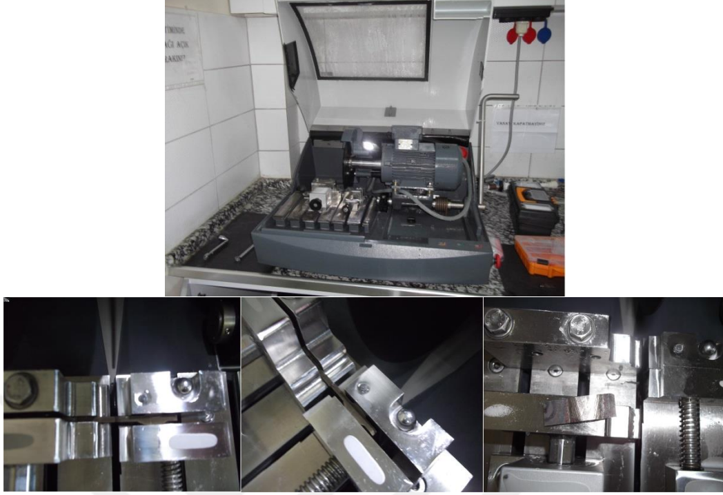
Şekil 6.21. Hassas Kesme cihazında kaynaklı numunelerden mikroyapı çıkartılması
