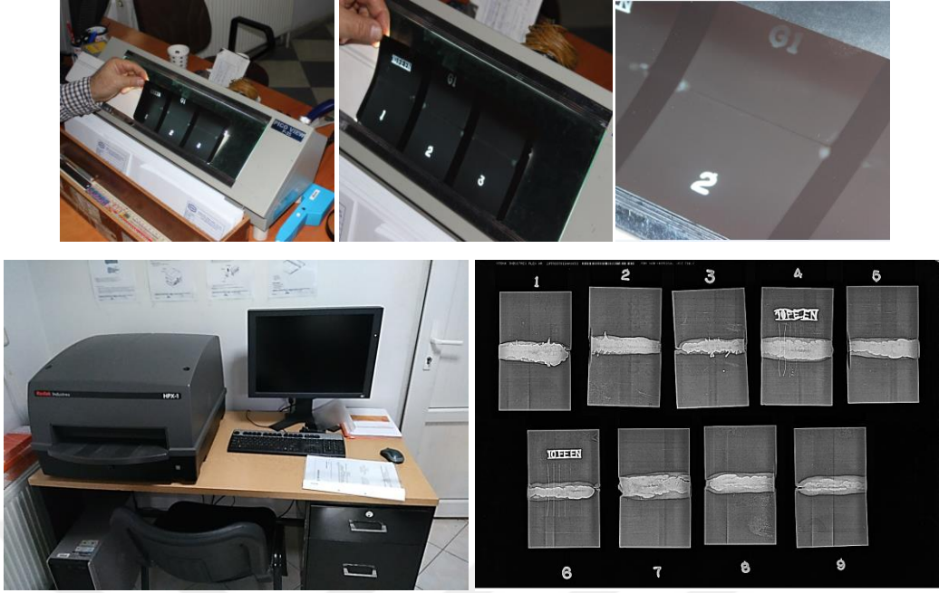
Şekil 6.14. Işık cihazında filmlerin incelenmesi ve elektronik çıktıdan radyografik raporun alınması
