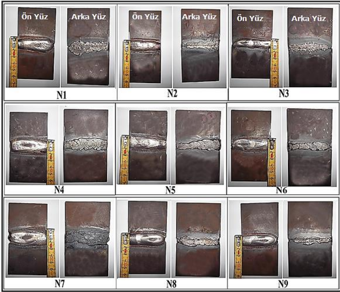
Şekil 6.11. Kaynaklı numunelerin ön ve arka dikiş makro resimleri
