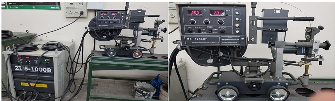
Şekil 6.7. ZD5-1000B / MZ-1250BF güç kaynağı ve kaynak traktör model serili tozaltı kaynak makinası ve kontrol panelleri
