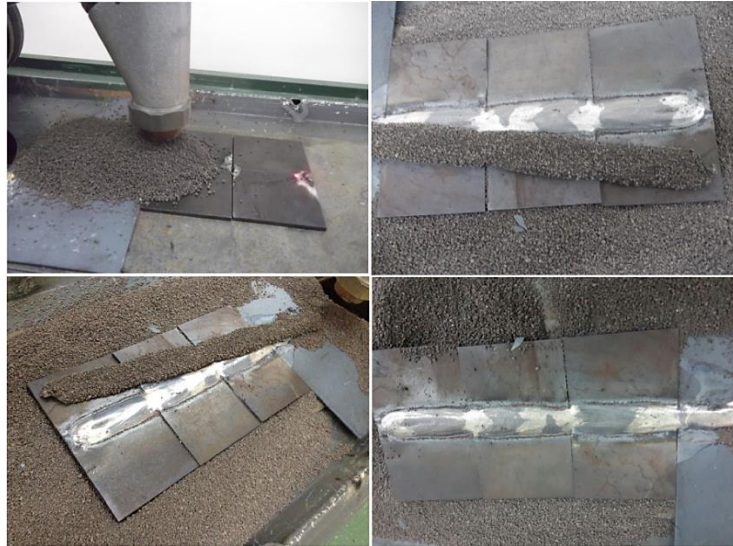
Şekil 6.9. Ramor 500 malzeme çiftlerinin tozaltı kaynağı sırasındaki resimleri
