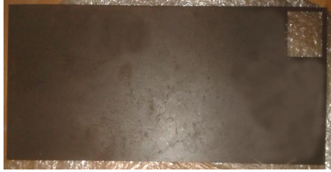
Şekil 6.2. Deneyde kullanılan 3 mm kalınlığında Ramor 500 zırh çeliği
