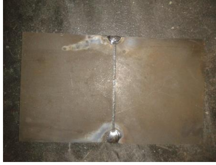
Şekil 6.5. Kaynak işlemi öncesi puntalama ile malzeme çiftlerini sabitleme
