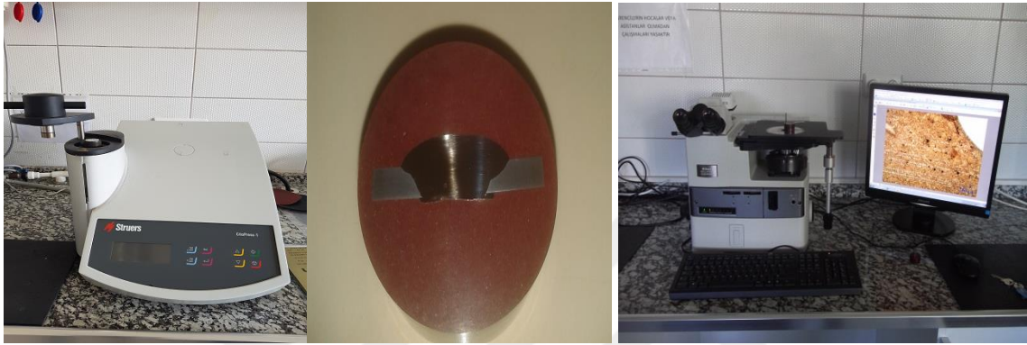
Şekil 6.24. Sıcak bakalite alma cihazı, bakalit numunesi ve optik mikroskop
