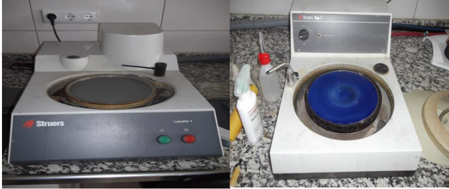
Şekil 6.27. Zımparalama cihazı, parlatma (çuhalama) işlemi
