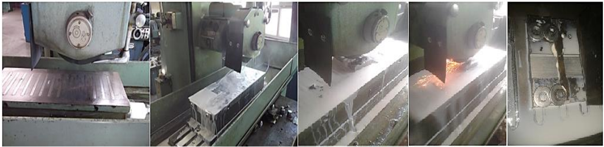
Şekil 6.19. Çekme numunelerinin bor sıvı soğutmalı taşlama makinası ile yüzey düzleştirme işlemleri
