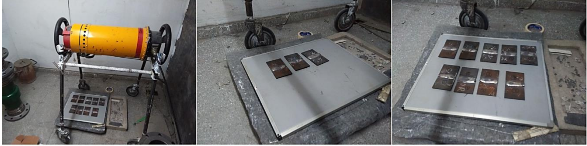
Şekil 6.13. Röntgen çekimi için hazırlanan numuneler
