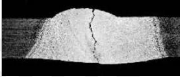
Şekil 3.21. Kaynak dikişinde sıcak çatlama örneği [64].
