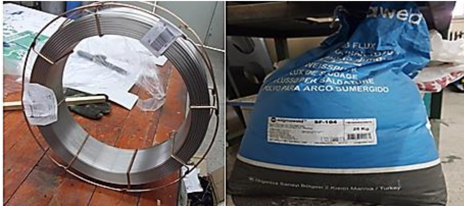
Şekil 6.1. SI-307 ilave kaynak teli ve SF-104 alümina bazlı kaynak tozu
