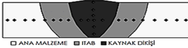
Şekil 6.30. Mikrosertlik numunesinden yatay ve dikey eksenden sertlik alınan noktalar
