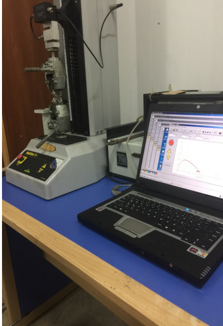
Şekil 2. 10:Cihazın elde ettiği değerlerin bilgisayara aktarılması
