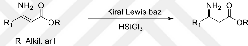
Şekil 2.20. Enamin esterlerin kiral Lewis bazı ile indirgenmesi
